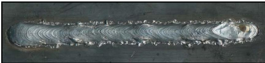
Figura 4.31 – Cordão de solda executado por processo de soldagem MAG, VAE= 7,5 m/min; sentido de soldagem empurrando.
