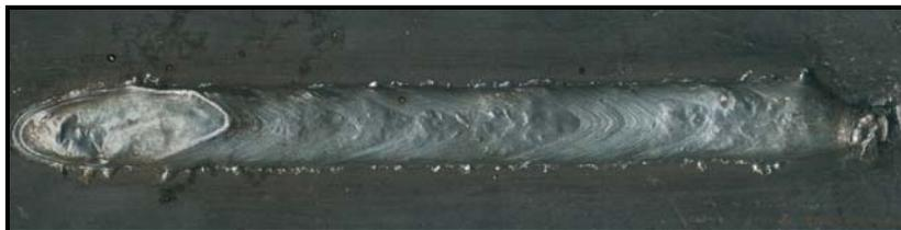
Figura 4.39 – Cordão de solda executado por processo de soldagem MAG-CW, VAE= 9 m/min, VAF= 5 m/min, sentido de soldagem puxando e posição do arame não energizado Twin.
