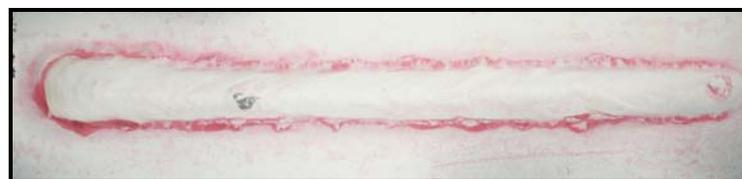
Figura 4.48 – Qualidade superficial dos cordões depositados pelo processo MAG com VAE= 9 m/min - E5.
