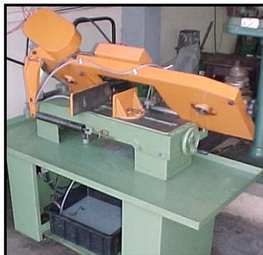
Figura 3.10 – Máquina automática de serrar (serra em fita).
