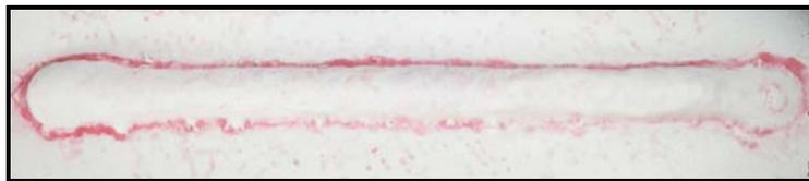
Figura 4.45 – Qualidade superficial dos cordões depositados pelo processo MAG-CW com VAE= 6 m/min e VAF= 3 m/min - E25R-Twin.
