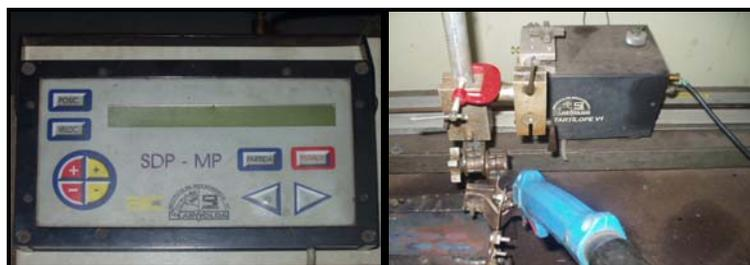
Figura 3.3 – Sistema de posicionamento e deslocamento automático da tocha.
