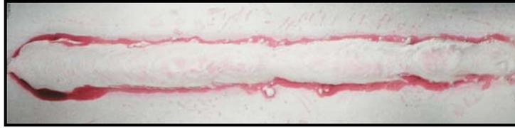
Figura 4.50 – Qualidade superficial dos cordões depositados pelo processo MAG-CW com VAE= 9 m/min e VAF= 5 m/min - E9-Tandem.
