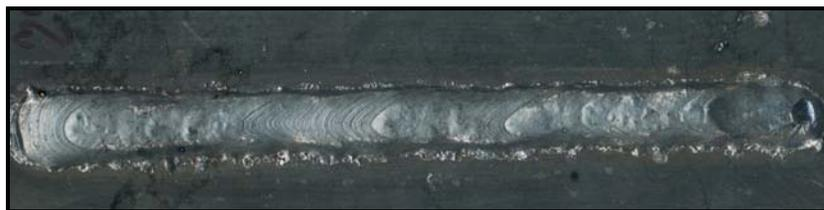
Figura 4.36 – Cordão de solda executado por processo de soldagem MAG-CW, VAE= 6 m/min, VAF= 3 m/min, sentido de soldagem empurrando, posição do arame não energizado Twin.
