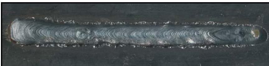
Figura 4.33 – Cordão de solda executado por processo de soldagem MAG, VAE= 9 m/min; sentido de soldagem empurrando.
