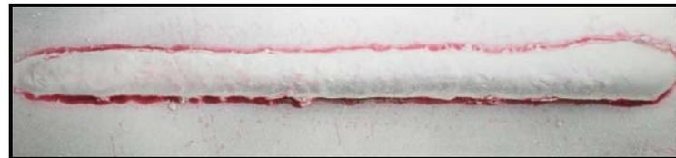
Figura 4.42 – Qualidade superficial dos cordões depositados pelo Processo MAG-CW com VAE= 7,5 m/min e VAF= 4 m/min - P17-R-Tandem.
