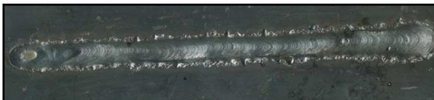
Figura 4.30 – Cordão de solda executado por processo de soldagem MAG, VAE= 6 m/min; sentido de soldagem puxando.
