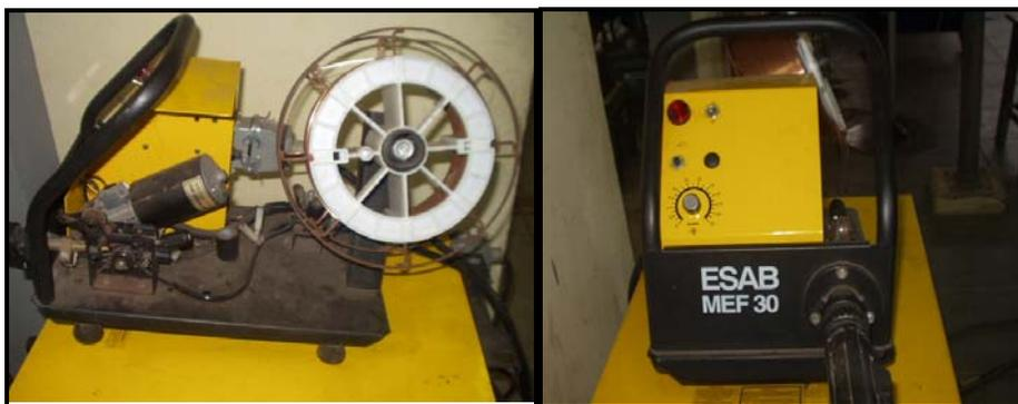
Figura 3.5 – Detalhes do sistema de alimentação auxiliar do arame frio.
