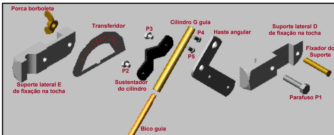
Figura 3.8 – Detalhe do suporte guia de alimentação do arame frio.
