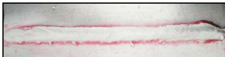
Figura 4.49 – Qualidade superficial dos cordões depositados pelo processo MAG com VAE= 9 m/min - P6.
