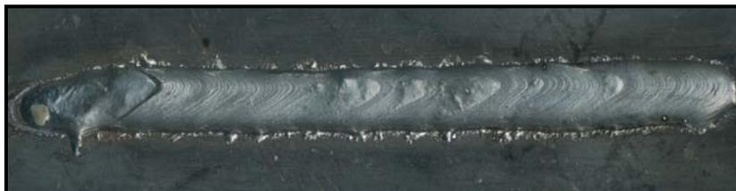
Figura 4.37 – Cordão de solda executado por processo de soldagem MAG-CW, VAE= 7,5 m/min, VAF= 4 m/min, sentido de soldagem puxando, posição do arame não energizado Twin.
