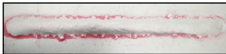
Figura 4.47 – Qualidade superficial dos cordões depositados pelo processo MAG com VAE 6= m/min - E1.
