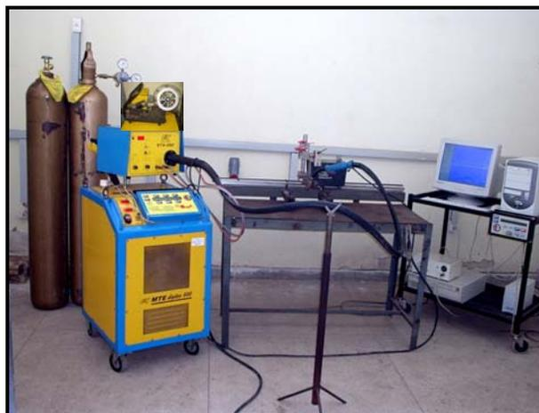
Figura 3.1 – Central de soldagem multiprocessos - Detalhes da bancada de soldagem MIG/MAG. Fonte: (LABSOLDA/UFPA).
