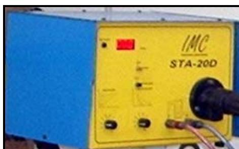
Figura 3.2 – Cabeçote de alimentação de arame. Modelo: STA20D. Fonte: (LABSOLDA/UFPA).
