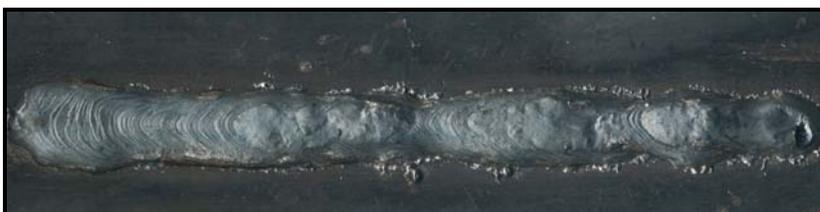
Figura 4.40 – Cordão de solda executado por processo de soldagem MAG-CW, VAE= 9 m/min, VAF= 5 m/min, sentido de soldagem empurrando e posição do arame não energizado Tandem.
