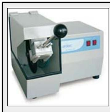
Figura 3.12 – Máquina de corte – cut-off. Fonte: (LABSOLDA/UFPA).
