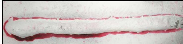
Figura 4.51 – Qualidade superficial dos cordões depositados pelo processo MAG-CW com VAE= 9 m/min e VAF= 5 m/min - P12-Tandem.
