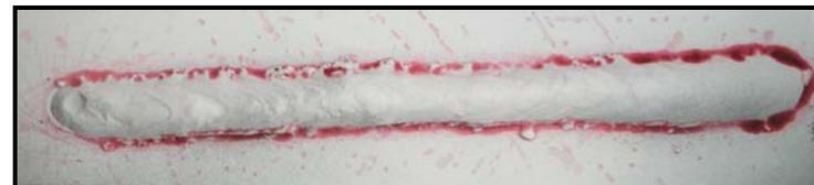
Figura 4.53 – Qualidade superficial dos cordões depositados pelo processo MAG-CW com VAE= 6 m/min e VAF= 3 m/min - P19-Twin.
