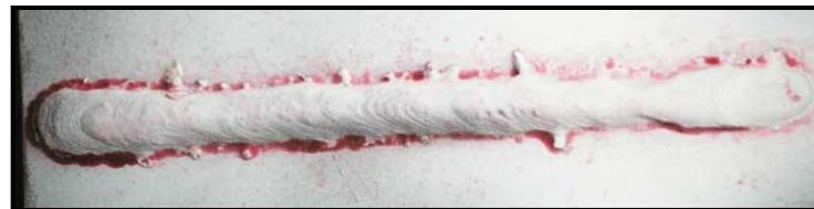
Figura 4.52 – Qualidade superficial dos cordões depositados pelo processo MAG-CW com VAE= 6 m/min e VAF= 3 m/min - E7-Tandem.
