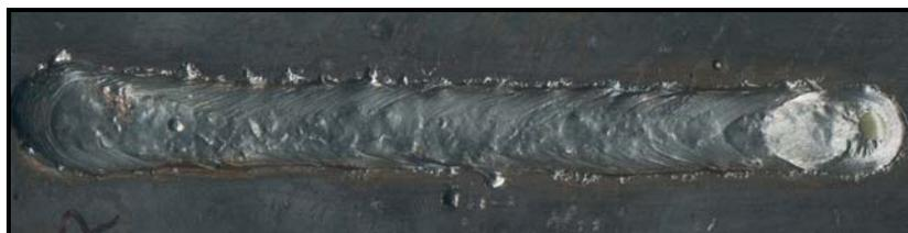
Figura 4.38 – Cordão de solda executado por processo de soldagem MAG-CW, VAE= 7,5 m/min, VAF= 4 m/min, sentido de soldagem empurrando, posição do arame não energizado Tandem.
