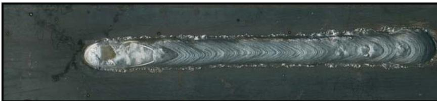
Figura 4.32 – Cordão de solda executado por processo de soldagem MAG, VAE= 7,5 m/min; sentido de soldagem puxando.
