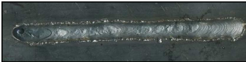
Figura 4.35 – Cordão de solda executado por processo de soldagem MAG-CW, VAE= 6 m/min, VAF= 3 m/min, sentido de soldagem puxando, posição do arame não energizado Twin.
