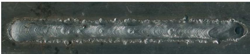
Figura 4.29 – Cordão de solda executado por processo de soldagem MAG, VAE= 6 m/min; sentido de soldagem empurrando.
