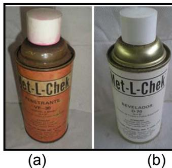
Figura 3.13 – Material para ensaio líquido penetrante; (a) Penetrante, (b) Revelador.
