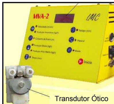
Figura 3.9 – Sistema de monitoração da produtividade em operações de soldagem. Fonte: (LABSOLDA/UFGA).
