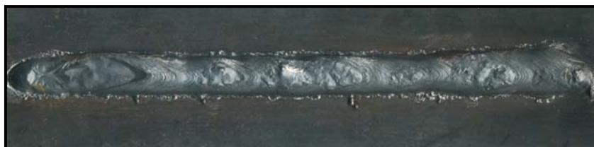
Figura 4.34 – Cordão de solda executado por processo de soldagem MAG, VAE= 9 m/min; sentido de soldagem puxando.
