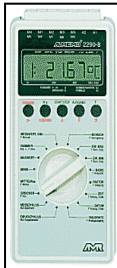
Figura 3.8 - Registrador de temperatura tipo ALMEMO
