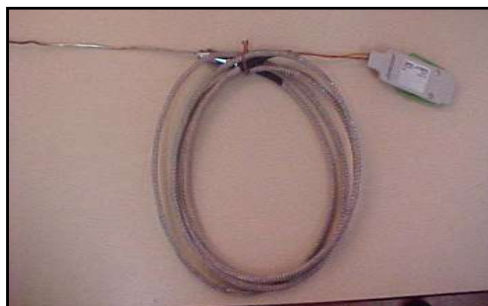
Figura 3.10 – Termopar de Chromel-Alumel do tipo K
