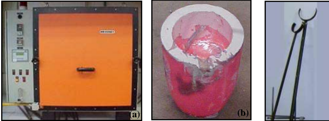
Figura 3.7- (a) Forno elétrico tipo mufla; (b) Cadinho; (c) Tenaz
