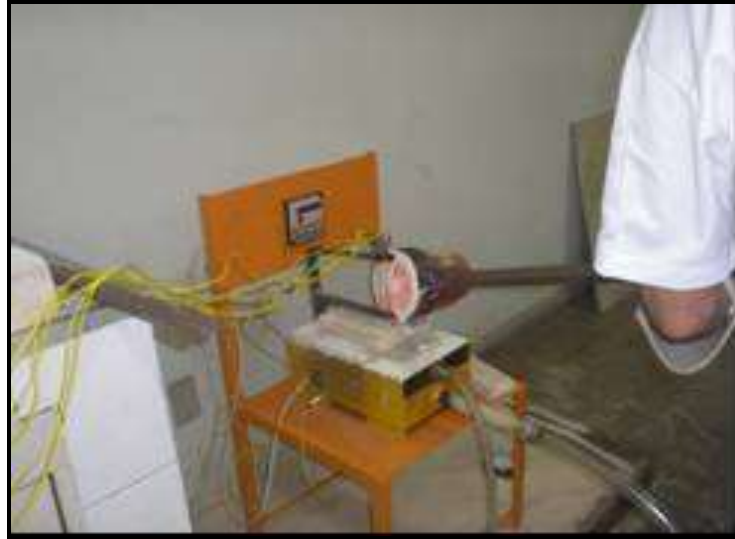
Figura 3.6 – Vazamento do metal líquido na lingoteira do dispositivo de solidificação com os termopares posicionados a 5, 10, 15, 30 e 50 mm à frente da câmara de refrigeração.
