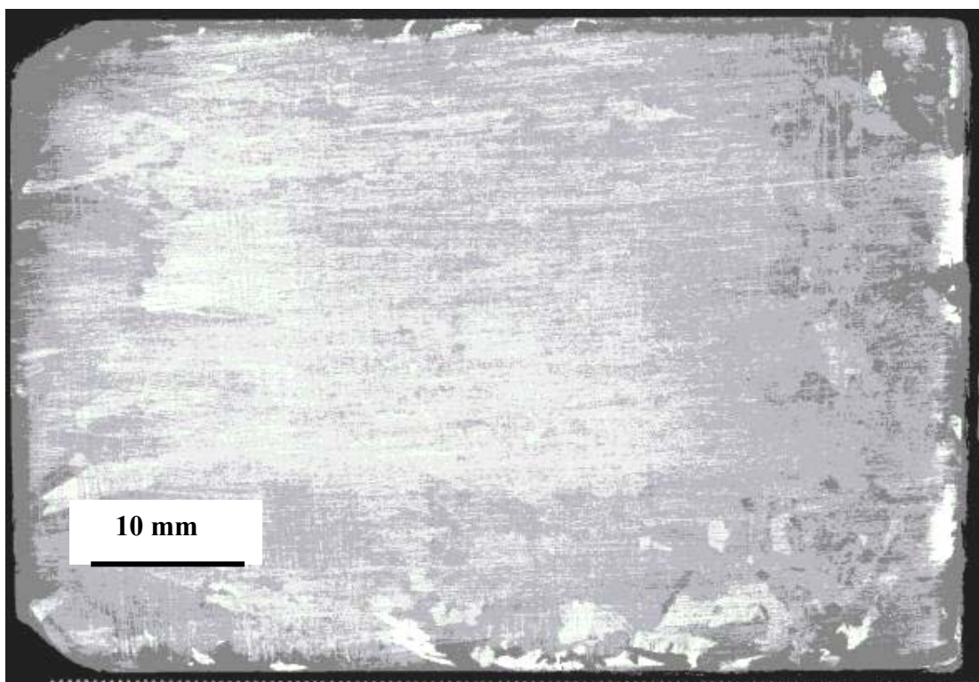
Figura 4.9: Macroestrutura de solidificação da liga Sn-5%Pb.
