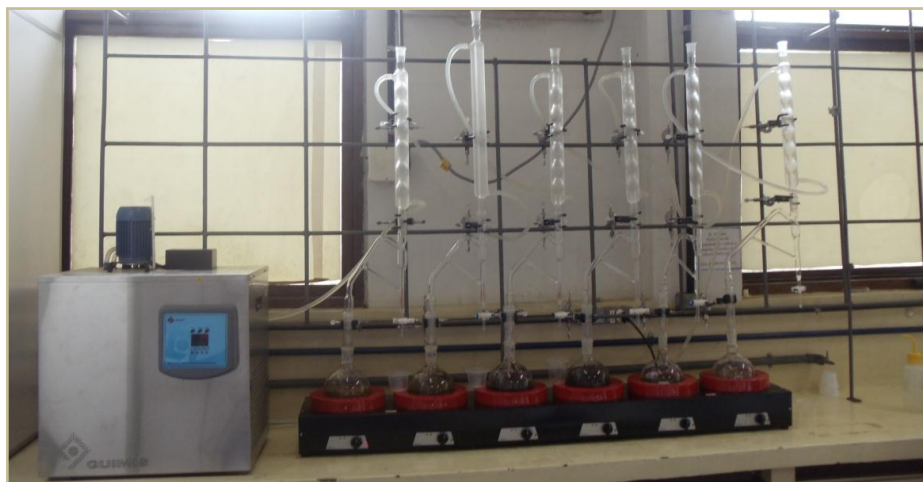
Figura 3 – Equipamento Clevenger – Utilizado para extração do óleo essencial da espécie P. aduncum , no Laboratório de Produtos Naturais da UFPA.
