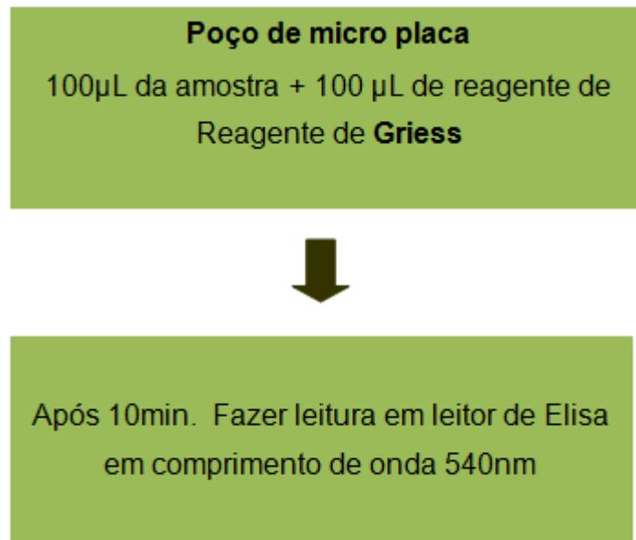
Figura 22- Procedimento para detecção de óxido nítrico.
