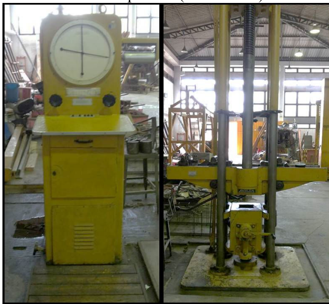
Figura 13 – Equipamento utilizado para os ensaios de resistência a compressão (LEC/UFPa).
