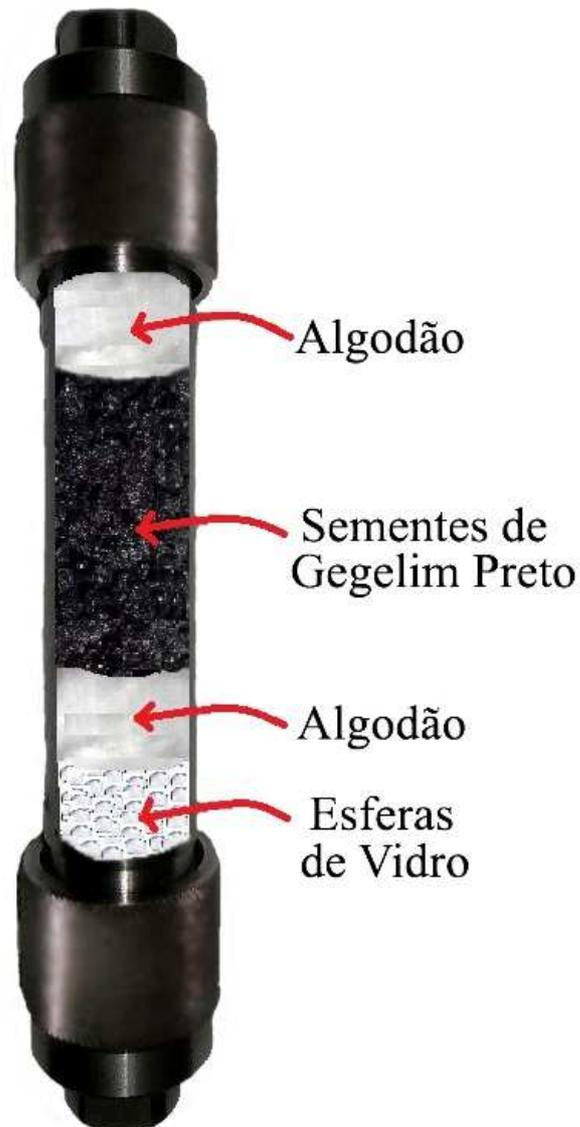
**Figura 3.3** – Ilustração do leito da coluna preparada para a extração.
