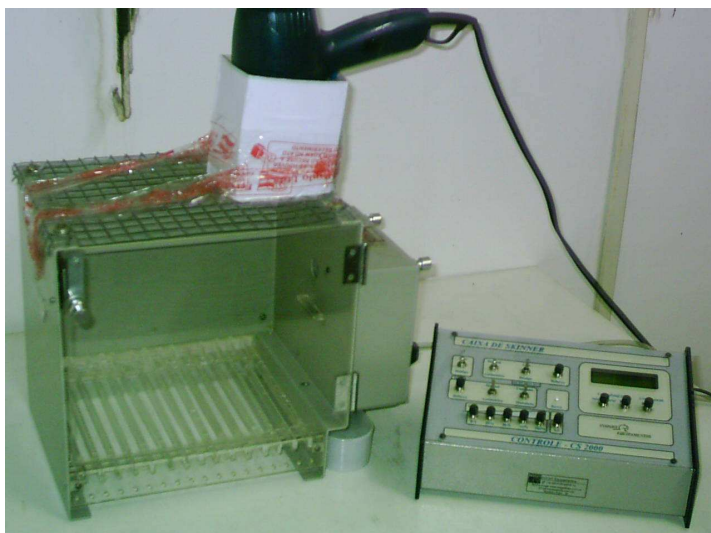
Figura 2. Caixa de condicionamento operante adaptada para a utilização do JAQ.
