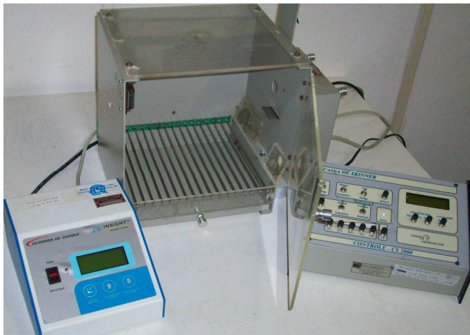
Figura 5. Caixa de condicionamento operante para a utilização do choque elétrico.
