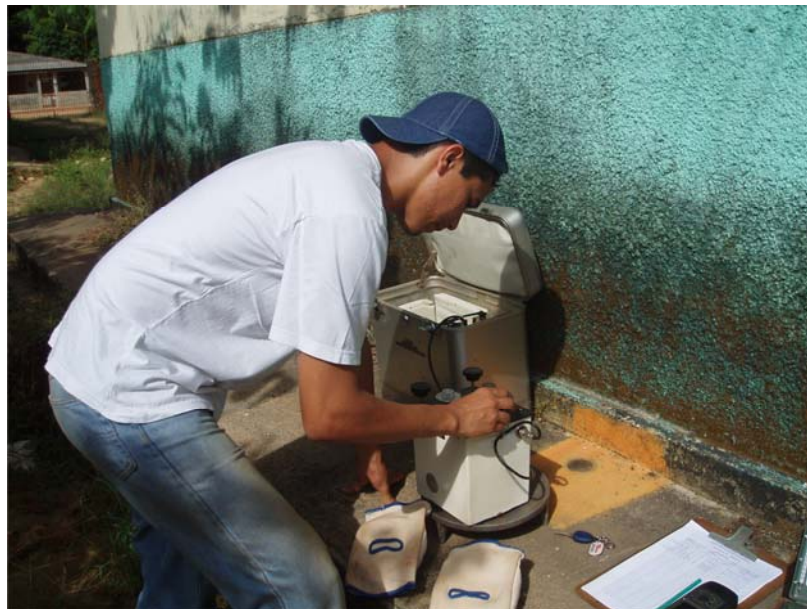
Figura 4.1 – Medida gravimétrica na estação base em Tartarugalzinho.
