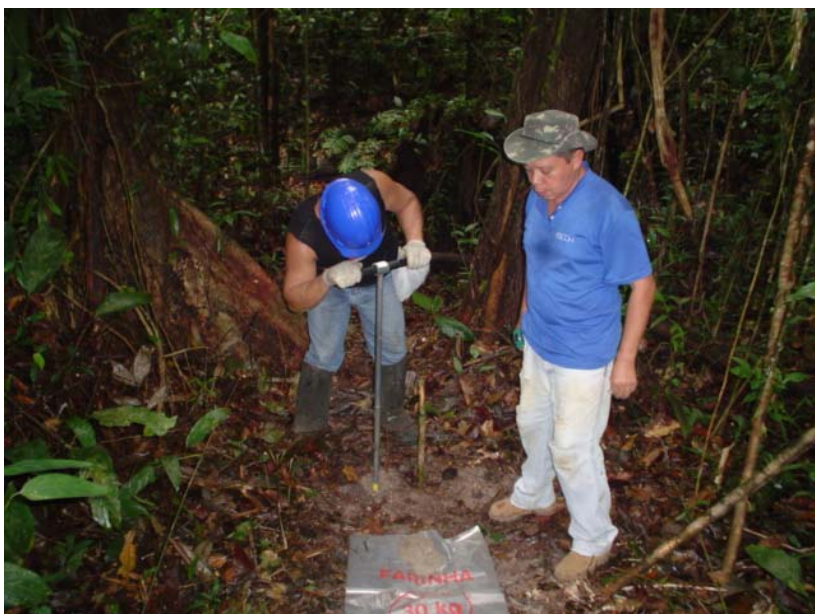
Figura A3 – Foto mostrando o trabalho de tradagem.
