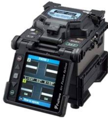
Figura 2.9 - Máquina de fusão de fibra óptica. (Fonte: FIBEROPTICS4SALE, 2010)
