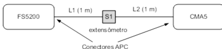
Fig. 7. Segunda montagem para teste a potência de saída do FS5200.
