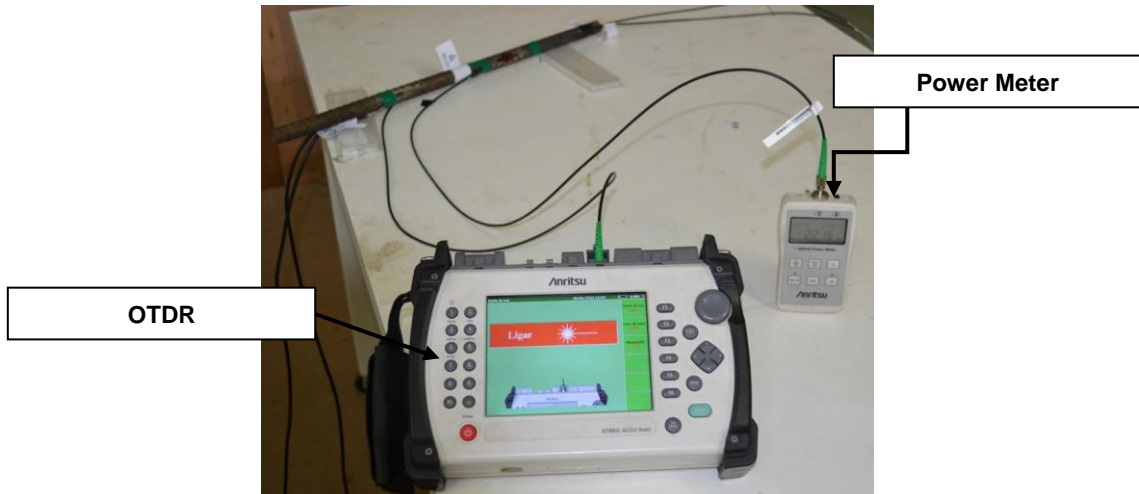
Figura 4.9 - Inspeção da fibra óptica pelo aparelho OTDR e Power Meter.
