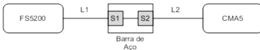
Fig. 6. Primeira montagem para teste da potência de saída do FS5200.
