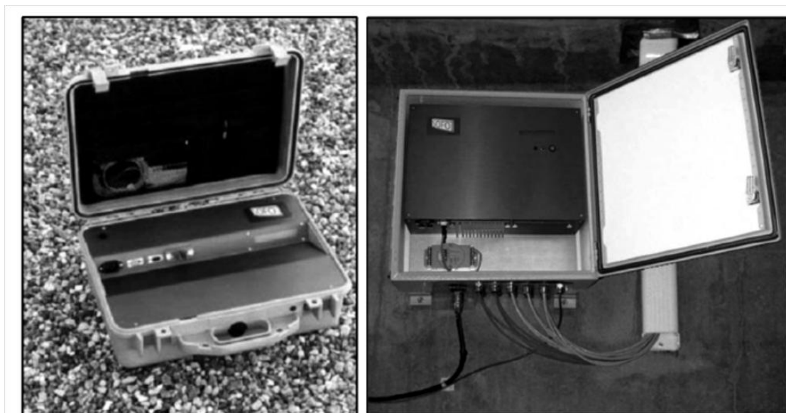
Figura 2.16 - Unidade de medição portátil do sistema SOFO (SMARTEC apud GLIŠIĆ e INAUDI, 2007).
