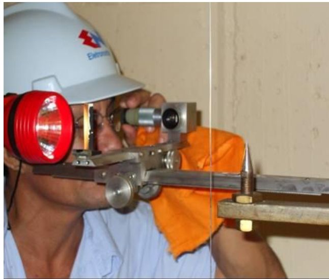
Figura 1.3 - Leitura do deslocamento do pêndulo feita por meio do coordenômetro 2 .
