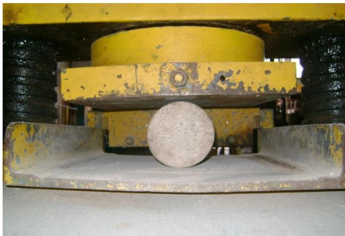
**Figura 3.30** – Ensaio de tração do concreto
