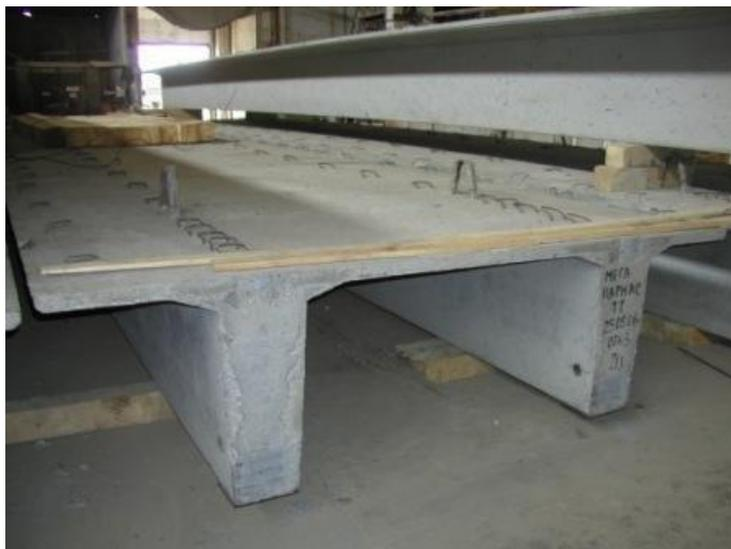
**Figura 2.3** – Pannel nervurado em duplo T (<http://www.olmetitaly.com/public/>)
