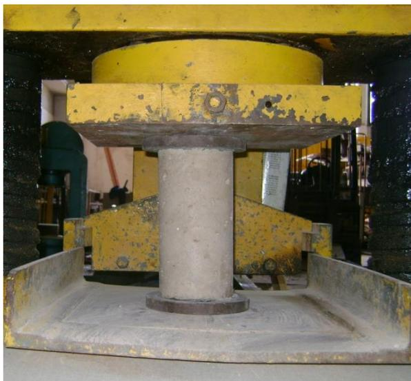
**Figura 3.29** – Ensaio de compressão do concreto
