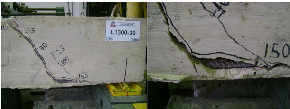
**Figura 4.35** – Destacamento da fissura de ruptura
