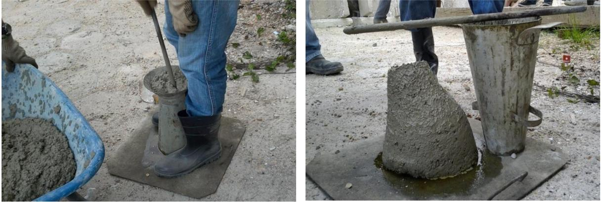
**Figura 3.15** – Ensaio de abatimento do tronco de cone (Slump Test)
