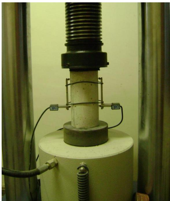
**Figura 3.31** – Ensaio de módulo de elasticidade do concreto
