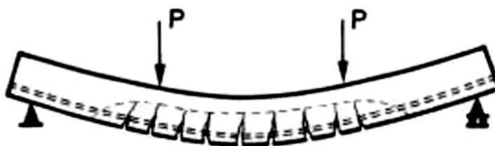
**Figura 2.9** – Ruptura por flexão e dentes de concreto (KANI, 1964).
