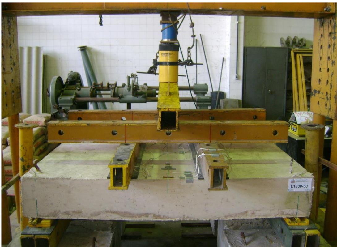
**Figura 3.26** – Detalhe do sistema de ensaio
