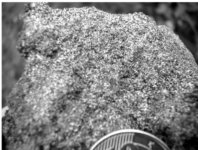
Figura 2: Detalhe de amostra de mão dos arenitos zeolíticos da Formação Corda, 1º ponto de amostragem (AZ1) utilizado neste trabalho. Os grãos de quartzo apresentam coloração avermelhada, em função de coating de goethita, enquanto as porções esbranquiçadas são o cimento zeolítico.
