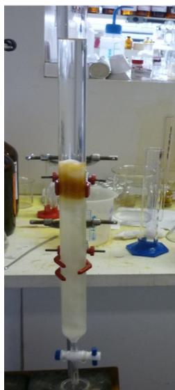
**Figura 6:** Coluna Cromatográfica do EDAPF utilizada no presente trabalho.
