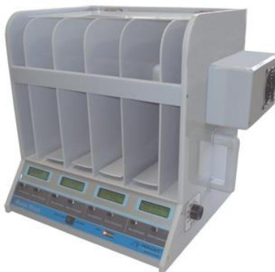
**Figura 10:** Figura do rota-rod.
