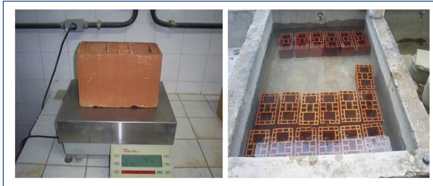
Figura 3.10 – Ensaio absorção d'água
