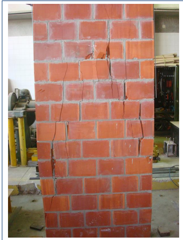
Figura 4.20 – Modo de ruptura das paredes, face frontal
