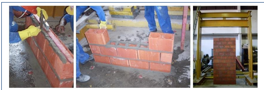
Figura 3.21 – Processo de modelagem das paredes
