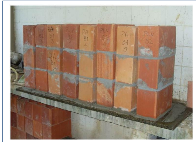
Figura 3.13 – Modelagem dos prismas
