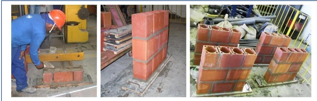
Figura 3.16 – Modelagem das mini-paredes
