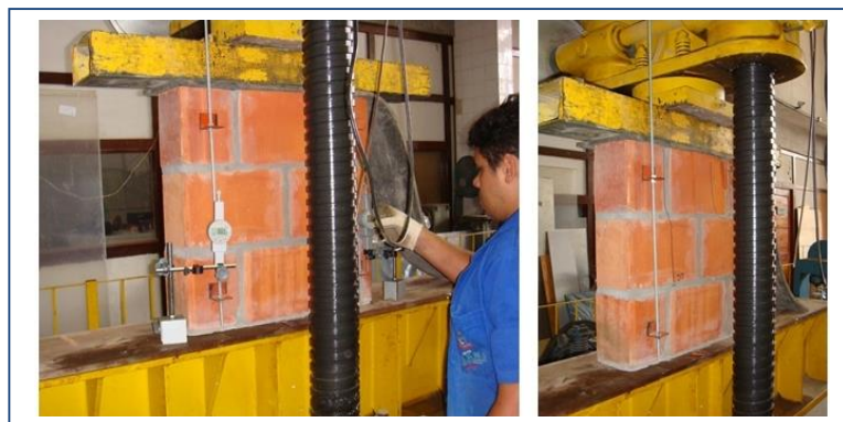
Figura 3.18 – Ensaio à compressão das mini-paredes
