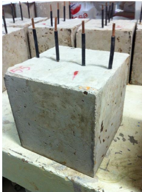
FIGURA 21 - CORPOS DE PROVA UTILIZADOS PARA O ENSAIO DE RESISTIVIDADE ELÉTRICA EM CONCRETO
