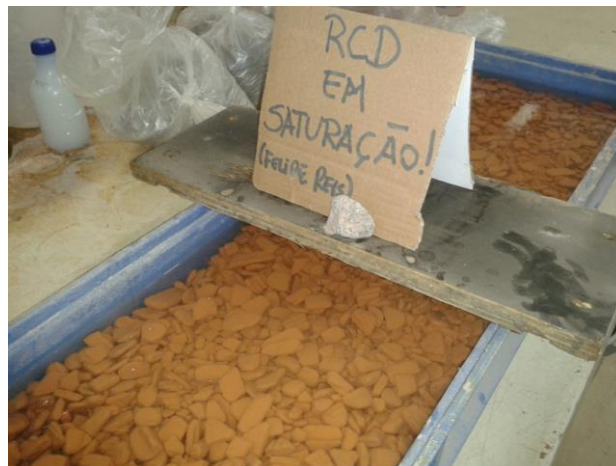
FIGURA 20 - AGREGADO CERÂMICO EM PROCESSO DE 100% SATURAÇÃO
