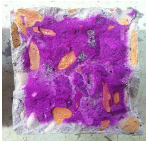
FIGURA 24 - AMOSTRA DA SEÇÃO DO CORPO DE PROVA CARBONATADO APÓS ASPERÇÃO DA SOLUÇÃO DE FENOLFTALEÍNA.
