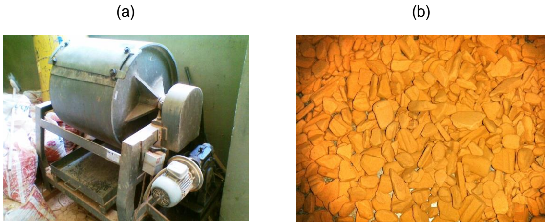
FIGURA 18 - MAQUINÁRIO DE ABRASÃO (1) E FORMA DOS AGREGADOS APÓS O PROCESSO DE BRITAGEM POR ABRASÃO (2).
