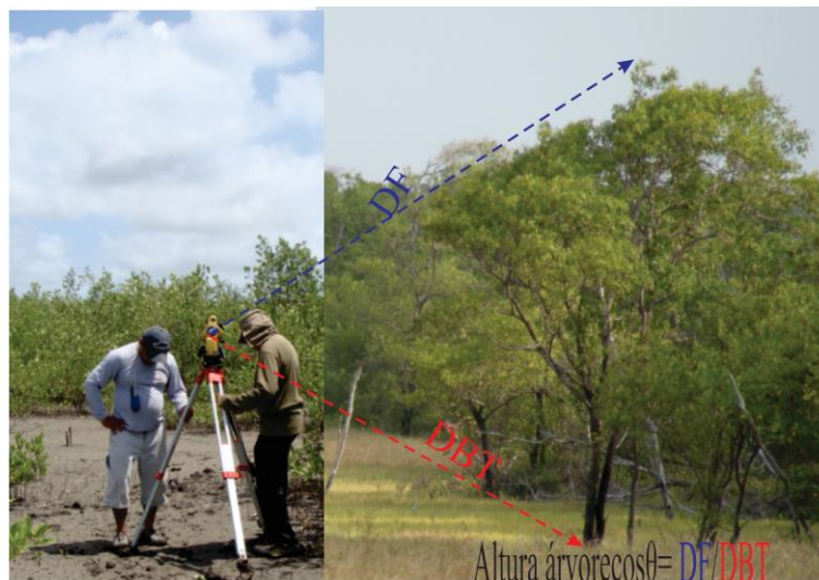
Figura 10: Medida da Altura da Árvore. DF = Distância da Estação total e a folha mais alta e DBT = distância da estação total em relação base do tronco.
