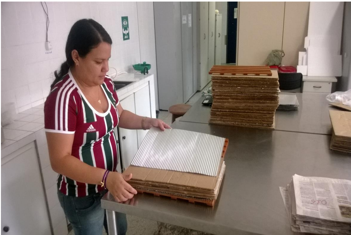
Figura 8B. Placa de alumínio que aumenta e distribui a temperatura nos envelopes.
