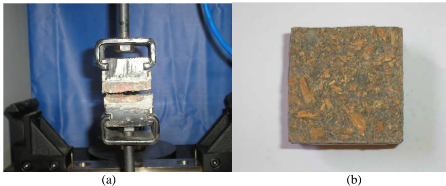
Figura 9 - Ensaios de tração perpendicular: (a) ensaio e (b) corpo de prova rompido
