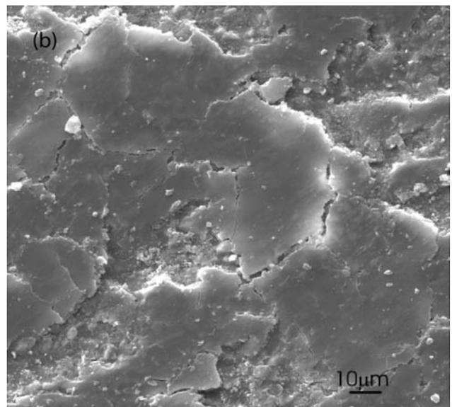
Figura 6: Micrografias de microscópio eletrônico de varredura mostrando superfícies desgastadas dos pinos de  $\gamma\text{-Al}_2\text{O}_3$  liofilizada com 0,5% de MgO (a) e 0,5% de  $\text{La}_2\text{O}_3$  (b).
