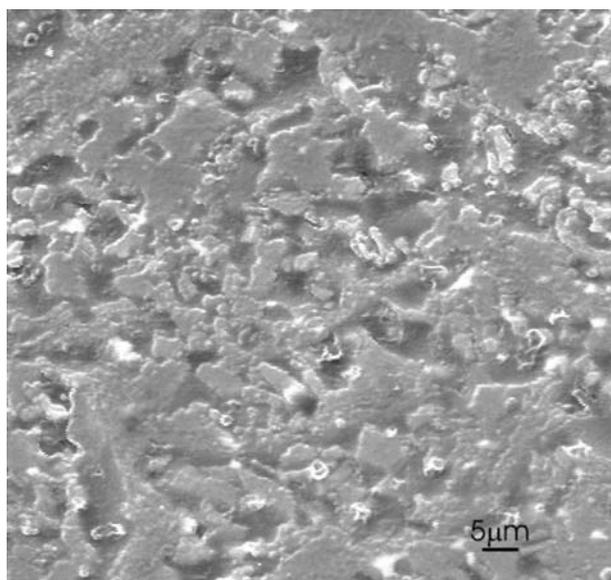
Figura 4: Micrografia de microscópio eletrônico de varredura da superfície desgastada do pino feito a partir do pó de  $\alpha\text{-Al}_2\text{O}_3$  liofilizada, com 0,5% de MgO, mostrando grãos alisados.
