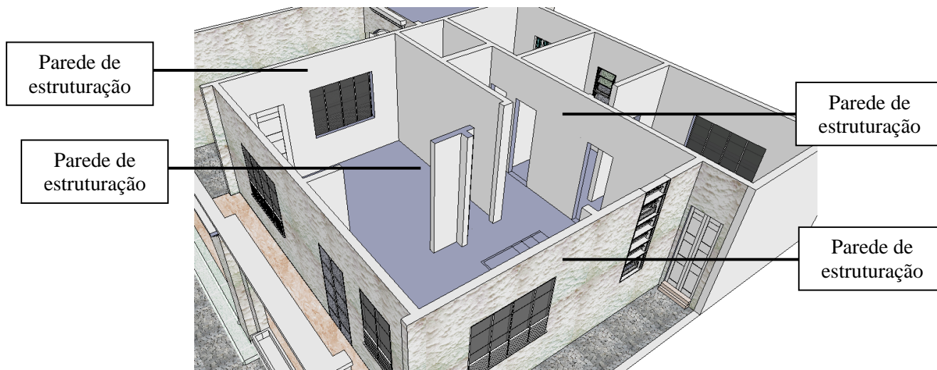
Figura 437: Marcação das paredes de sustentação com aplicação de tijolo em singelo.
