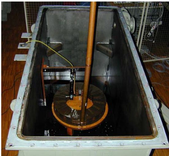
Figura 5.1: Transformador utilizados nos experimentos de [1] e modelado nas simulações de validação numérica.
