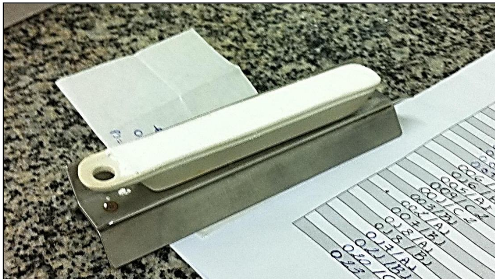
Figura 5 - Suporte para amostras do SP3D – Nippon Corporation. Fonte: NMT-UFGA (2012).
