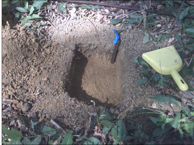
Figura 15. Minitrincheira para coleta de solo usado na análise granulométrica
