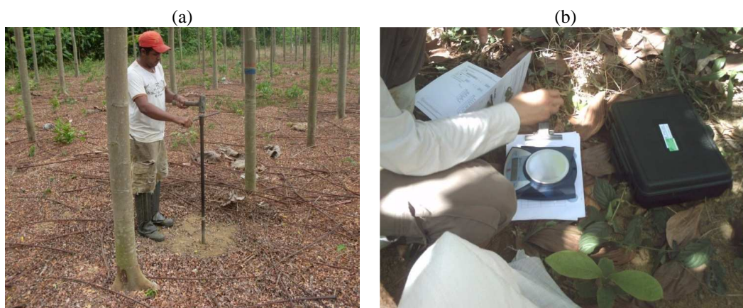
Figura 14. Coleta de solo (0 a 10 cm) para determinação da umidade do solo. (a) momento da coleta e (b) pesagem no campo para determinação da massa úmida.
