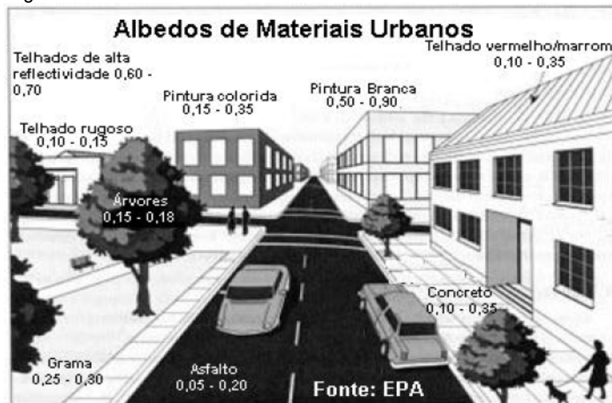
Figura 1- Albedos de materiais urbanos.
