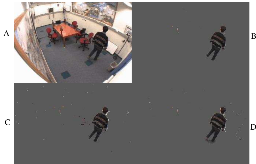
Figura 34: Resultados com a seqüência de imagens 03 e três tipos de classificação dos pixels . A) imagem de referência com objeto; B) Classificação do Pixel 01; C) Classificação do Pixel 02; e D) Classificação do Pixel 03.
