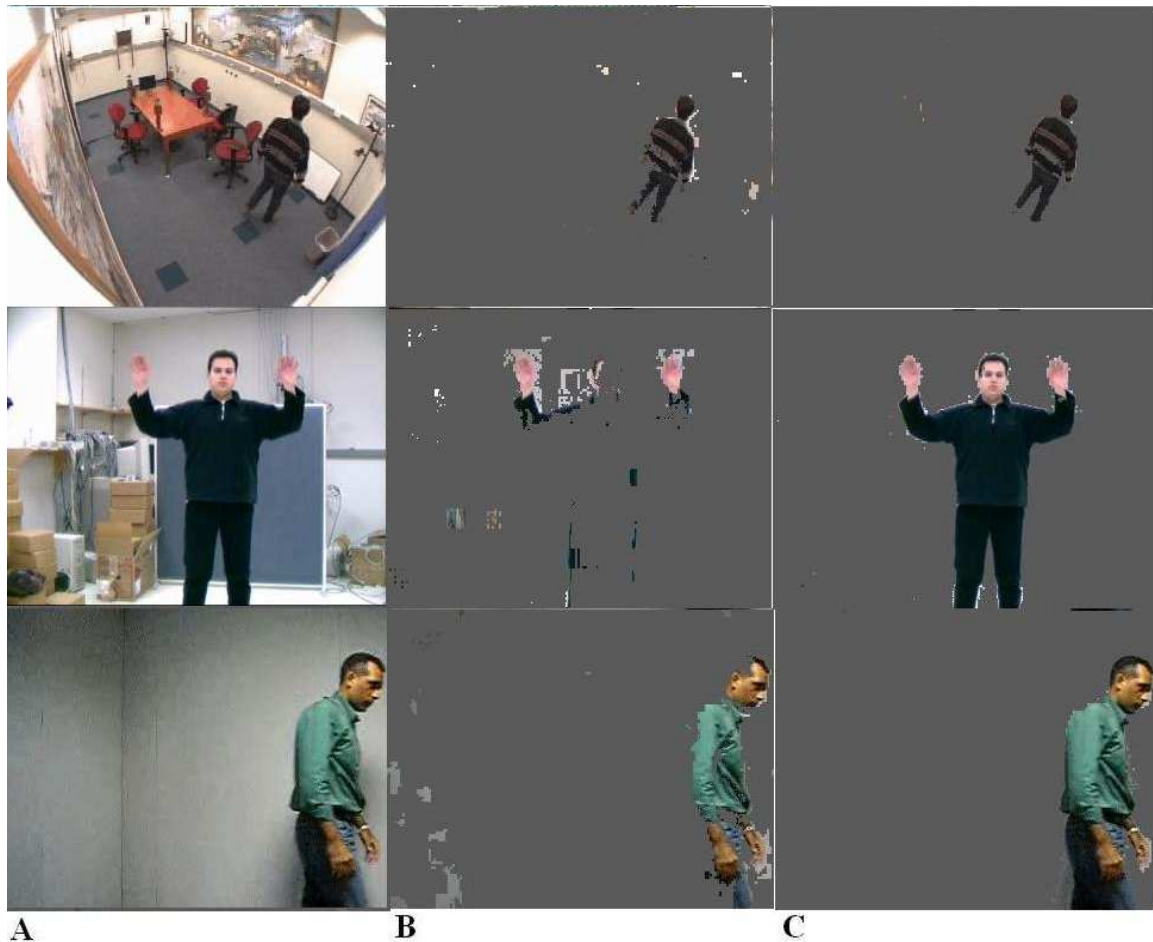
Figura 56: Resultados com as seqüências de imagens 03, 04 e 05 obtidas utilizando-se o método gaussiano com adaptação recursiva e taxa de atualização igual a 0,0025 (B) e o método gaussiano com função de compensação de variação do pixel (C).
