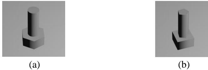
Figura 4.7 - Exemplo de equilíbrio no detalhamento de objetos 3D. (a) Modelo 3D detalhado. (b) Modelo 3D simples
