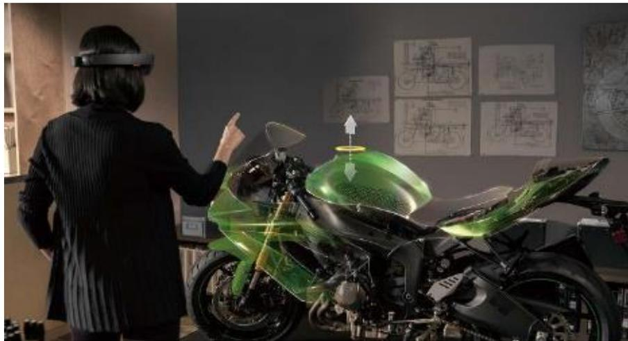
Figura 2.3 - Uso do Microsoft HoloLens para manutenção virtual de uma moto
