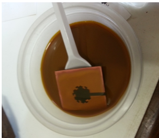
Figura 5.2 Processo de corrosão da placa metálica.
