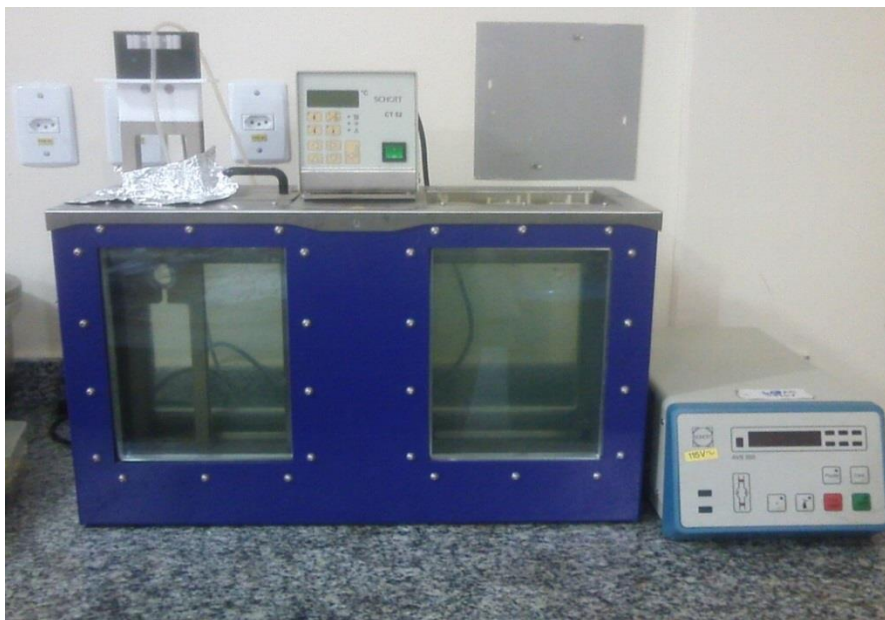
Figura 12: Viscosímetro Schott CT 52 com capilares de vidro e banho termostato. (foto: Autor)
