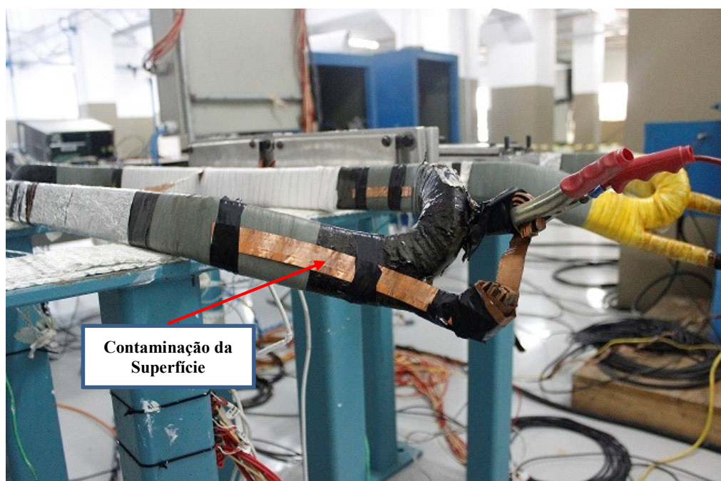
Figura 6.44 - Contaminação da superfície da bobina com uma fita de cobre.
