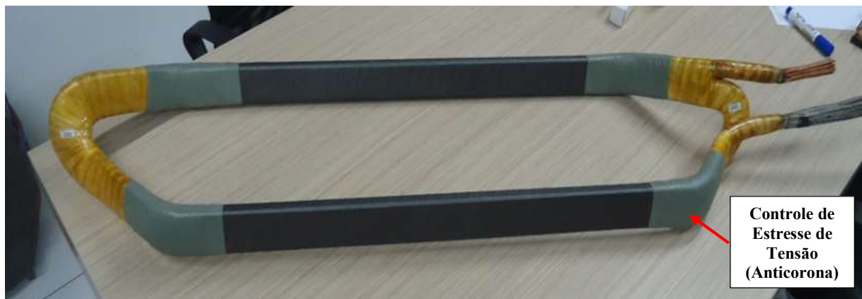
Figura 6.3 – Bobina 6,9 kV e classe F.
