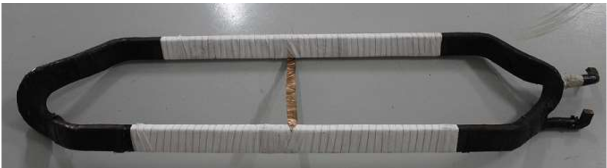
Figura 6.1 – Bobina de 6,9 kV e classe B.
