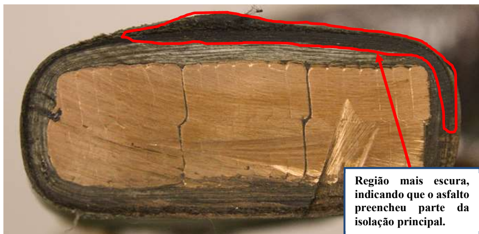
Figura 6.59 – Corte transversal na bobina nº 15.
