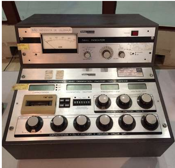
Figura 6.5 – Ponte Schering para medição de capacitância e perdas dielétricas.
