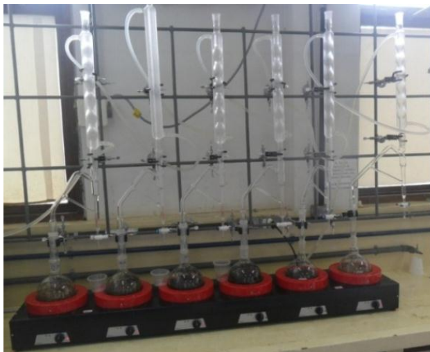
FIGURA 6- Sistemas de vidro do tipo Clevenger modificado, acoplados a sistemas de refrigeração.
