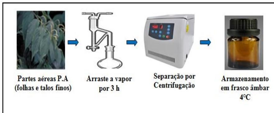
**Figura 19:** Esquema de obtenção do OEPA.
