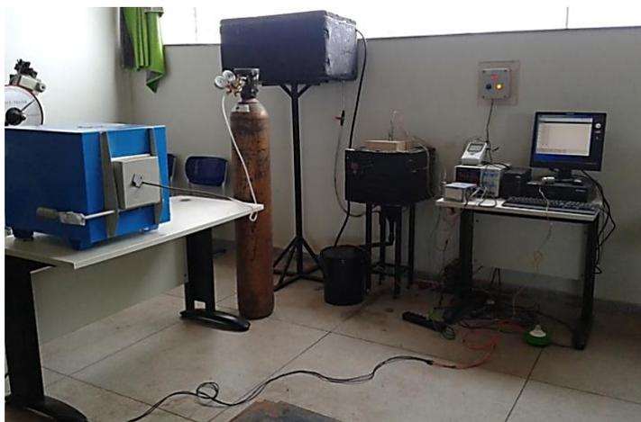
**Figura 3.17** - Dispositivo de solidificação unidirecional com sistemas de aquisição de dados térmicos.
