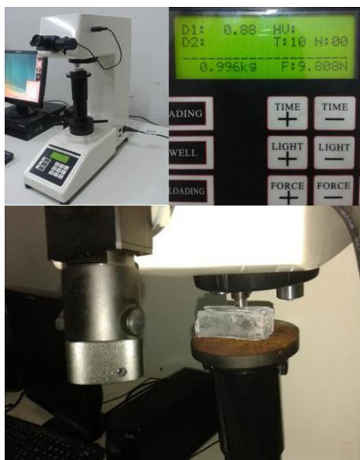
**Figura 3.26** - Microdurômetro usado para realizar o ensaio de microdureza dos materiais estudados.
