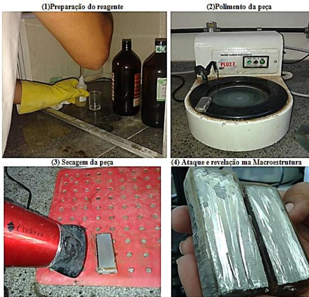
**Figura 3.20** - Etapas de tratamento da superfície do material para a revelação da macroestrutura.
