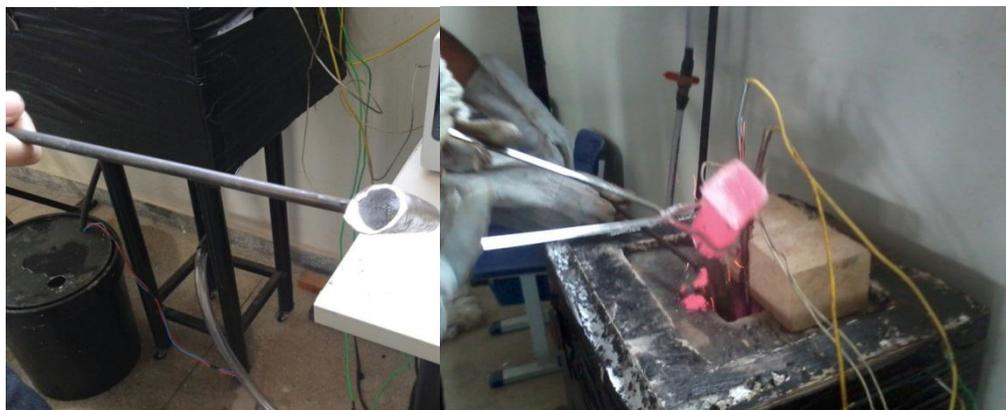
**Figura 3.14** - Inserção do material fundido dentro do dispositivo de solidificação unidirecional com auxílio do instrumento de direcionamento de fluido.
