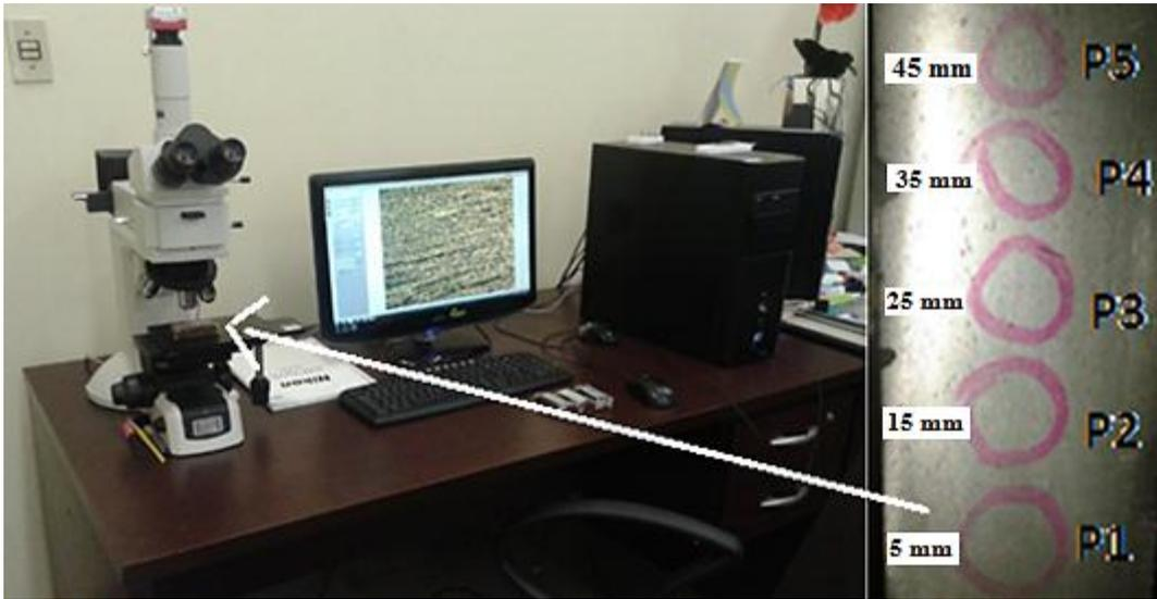
**Figura 3.21** - Microscópio óptico, ferramenta utilizada para obtenção das imagens das microestruturas, Al-2% Ni 1,5 NTC.
