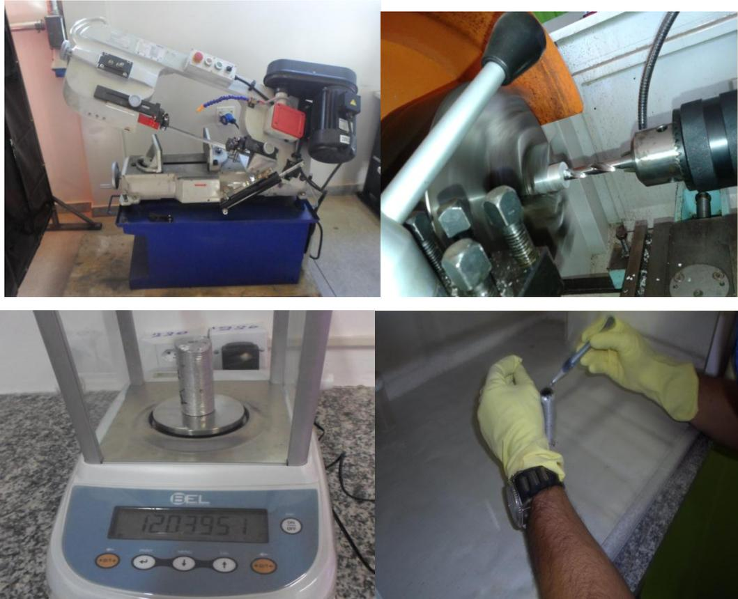
**Figura 3.12** - Corte e Usinagem e inserção do Nanotubo de Carbono no interior da liga Al-2%Ni.
