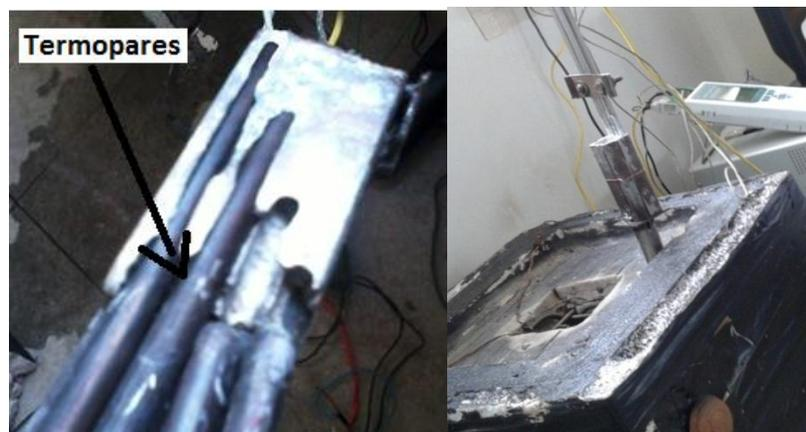
**Figura 3.15** -Termopares acoplados na material solidificado para retirada de dados térmicos.
