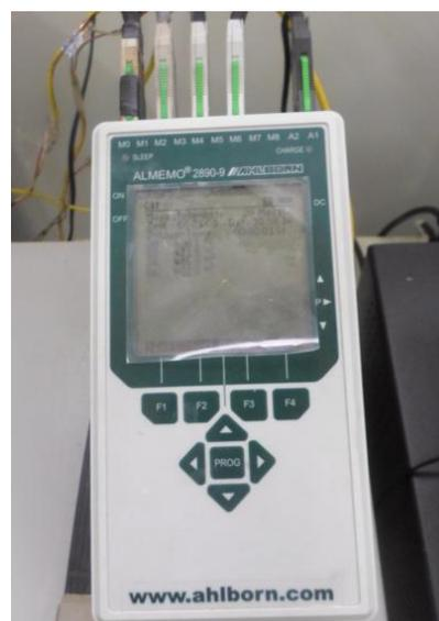
**Figura 3.16** - Almemo, equipamento de coleta de dados térmicos.
