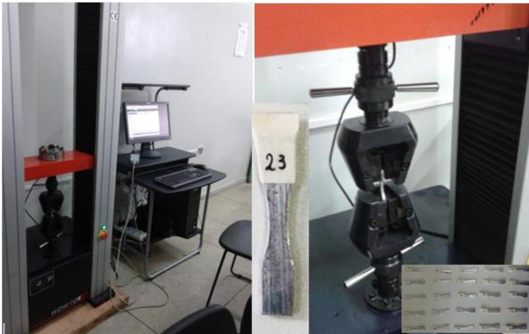
**Figura 3.25**- Máquina de ensaio universal de tração, momento do ensaio do corpo de prova.
