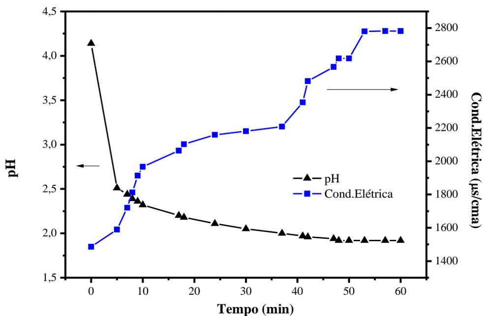
**Figura 4.12** - Variação do pH e da condutividade elétrica ao longo do tempo na extração de cobre por membranas contactores utilizando LIX84I como extratante, Querosene como solvente, pH inicial=4, T=25°C, Cu=1,194 g/L, Extratante=20%(v/v).
