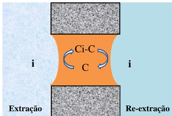
**Figura 2.25** - Transferência da espécie *i* através de um transportador *C*. Adaptado de DRIOLI et al., (2005).
