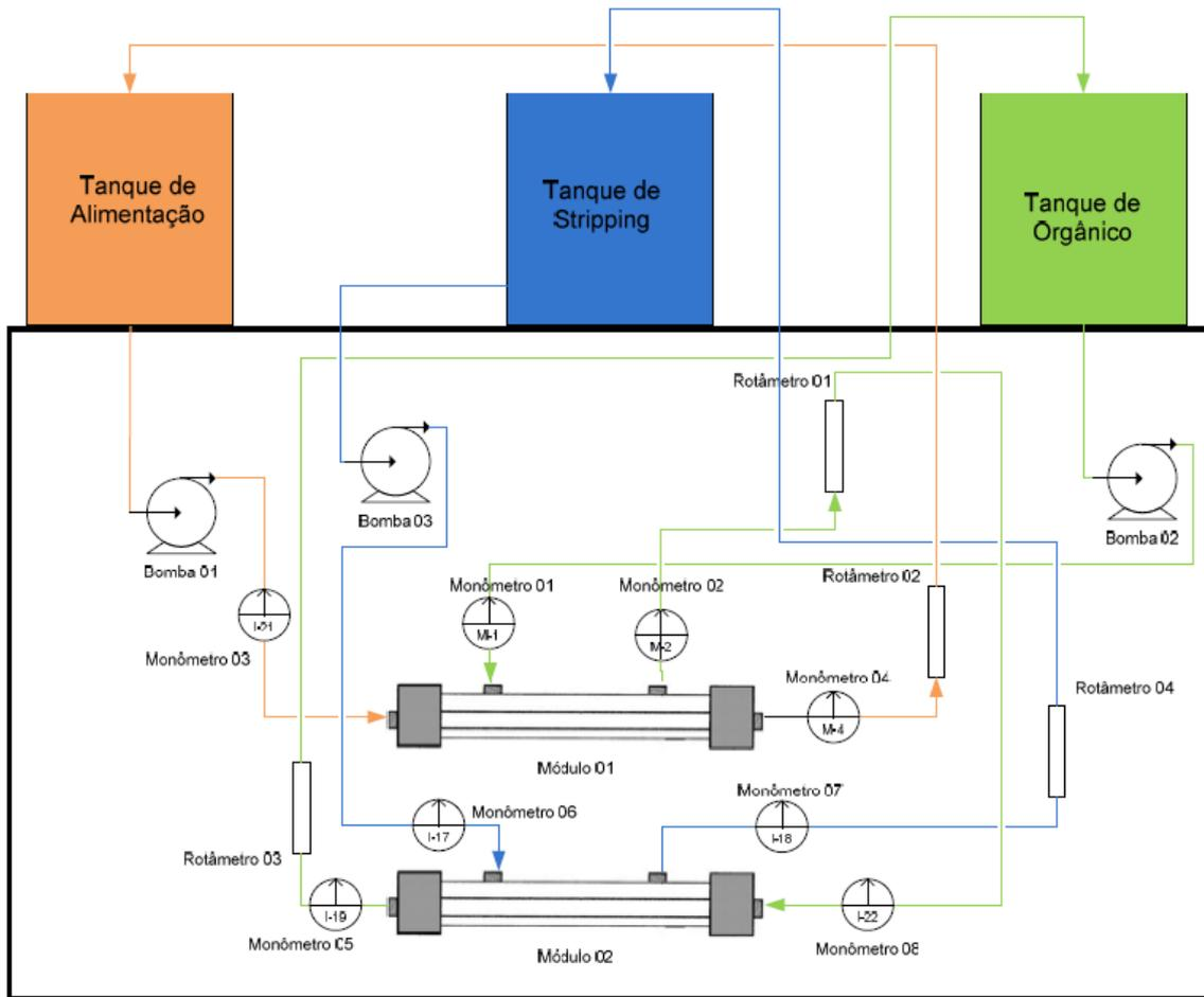
**Figura 3.5** – Representação esquemática do sistema de extração de metais por contactores com membranas.
