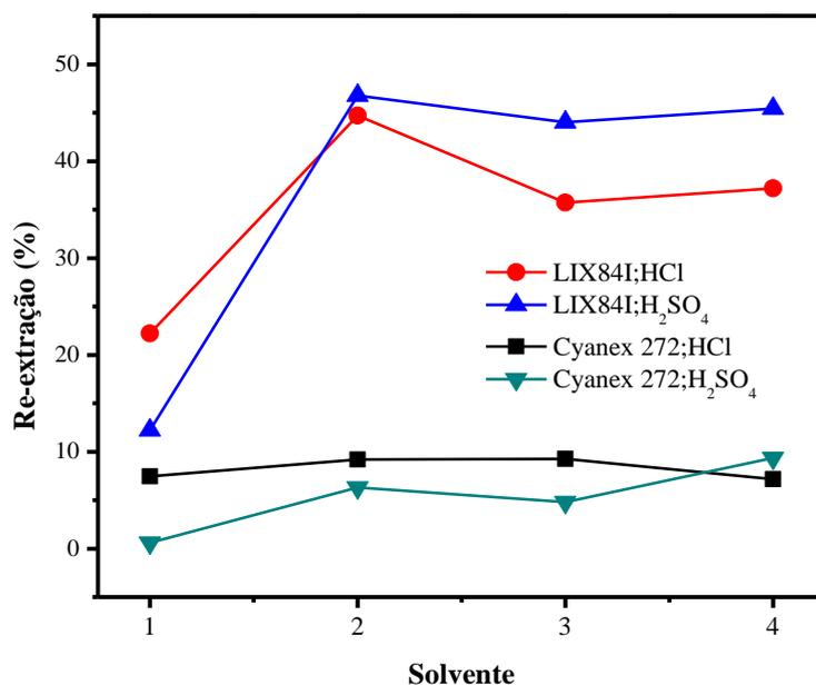
**Figura 4.6** - Influência da solução de *strip* e do solvente na re-extração de cobre em batelada utilizando Cyanex 272 como extratante, Octanol (1), Querosene (2) e Decalina (3), Exxol D80 (4) como solventes, pH inicial=4, T=25°C, Cu=1,194 g/L, Extratante=20%(v/v), Strip = 2M.
