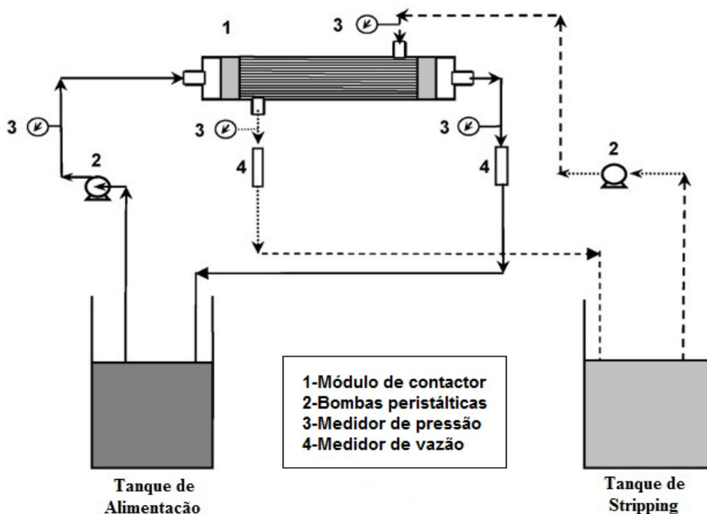
**Figura 2.26** – Diagrama esquemático de um sistema de membranas líquidas suportadas em fibra oca em contra-corrente (LOTHONGKUM et al., 2009).
