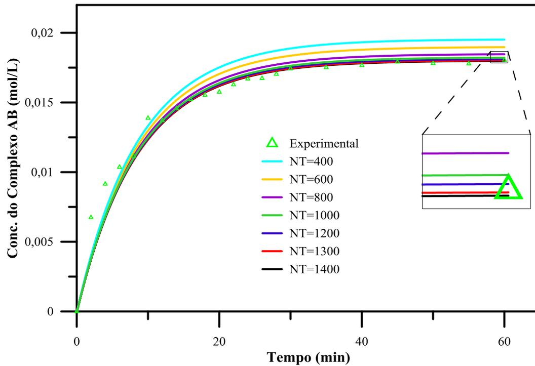
**Figura 4.21** – Análise gráfica de convergência para a cinética de complexação metal-extratante (AB) utilizando o sistema de contactor com membranas.
