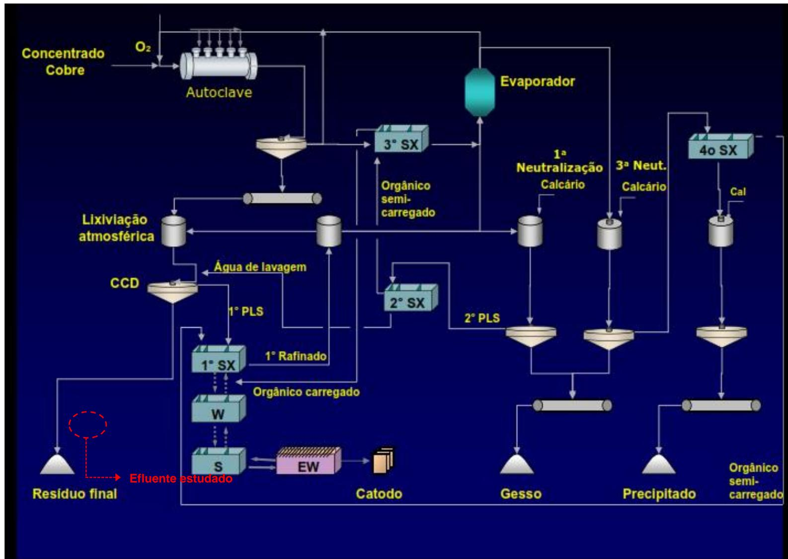
Figura 3.3 – Fluxograma geral do processo da UHC (OLIVEIRA e LIMA, 2008).
