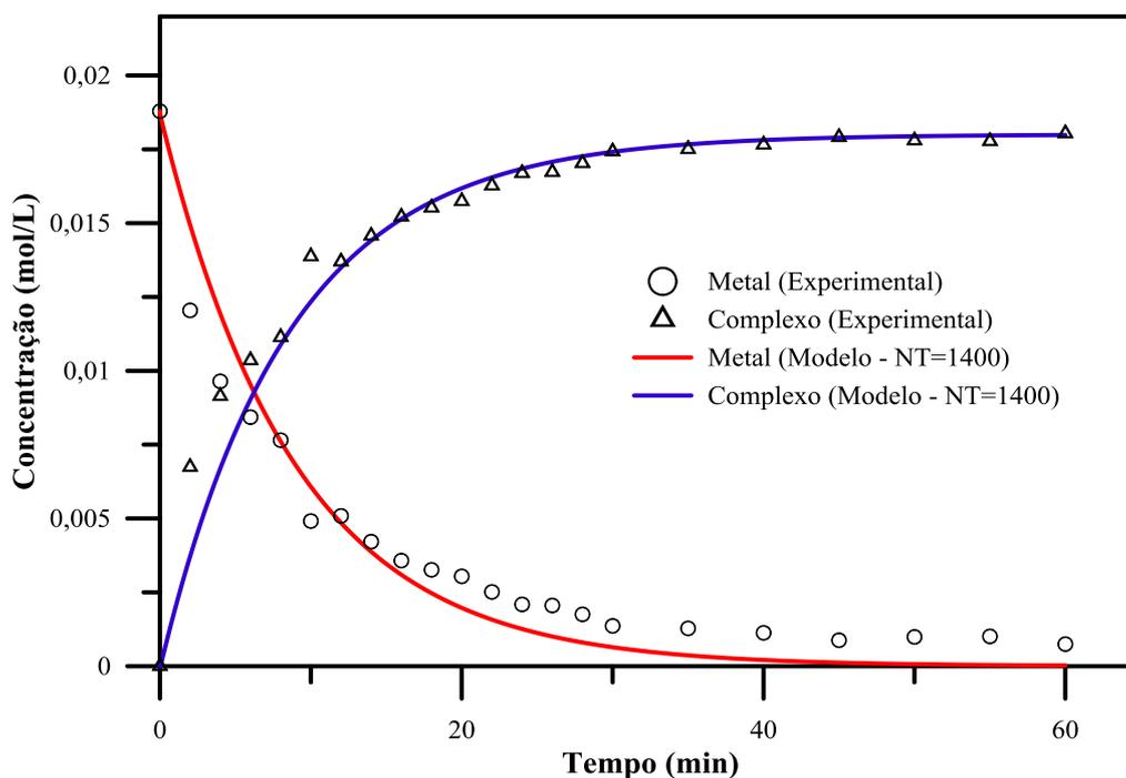
**Figura 4.17** – Comparação dos resultados experimentais com o modelo proposto através da cinética de extração do cobre através do sistema de contactor com membranas utilizando LIX84I como extratante.
