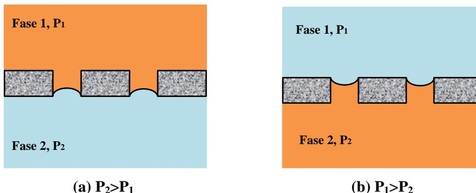
**Figura 2.23** - Contato entre a fase 1 e fase 2 através de um contactor com membrana quando (a) fase 1 molha a membrana; (b) fase 2 molha a membrana. Adaptado de CRISCUOLI (2009).
