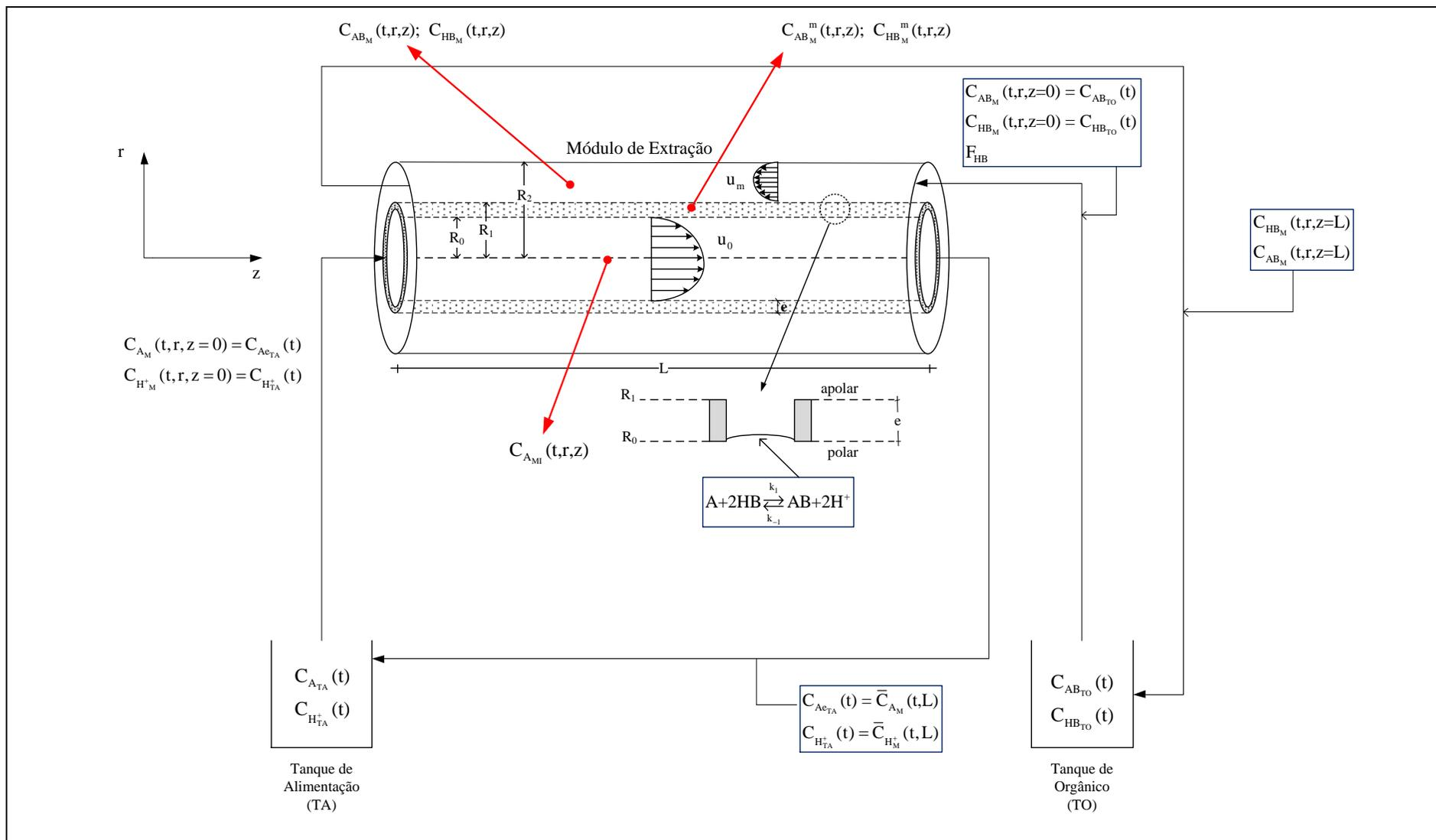
**Figura 3.7** - Esquema representativo do módulo de extração contendo uma fibra-oca.
