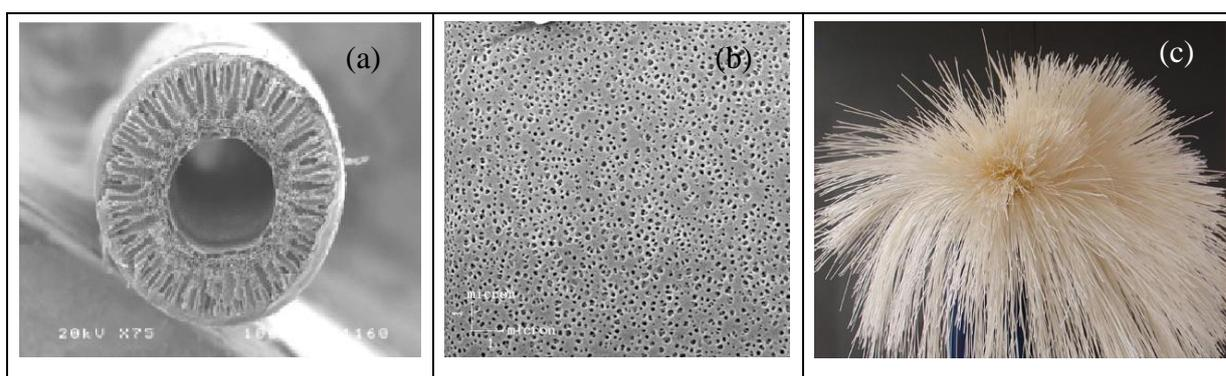
**Figura 2.12** – Membranas de microfiltração do tipo fibra (a) Fotomicrografias seção transversal; (b) Fotomicrografias superfície porosa; (c) feixe empacotado de membranas utilizado em módulos comerciais (PAM MEMBRANAS SELETIVAS).
