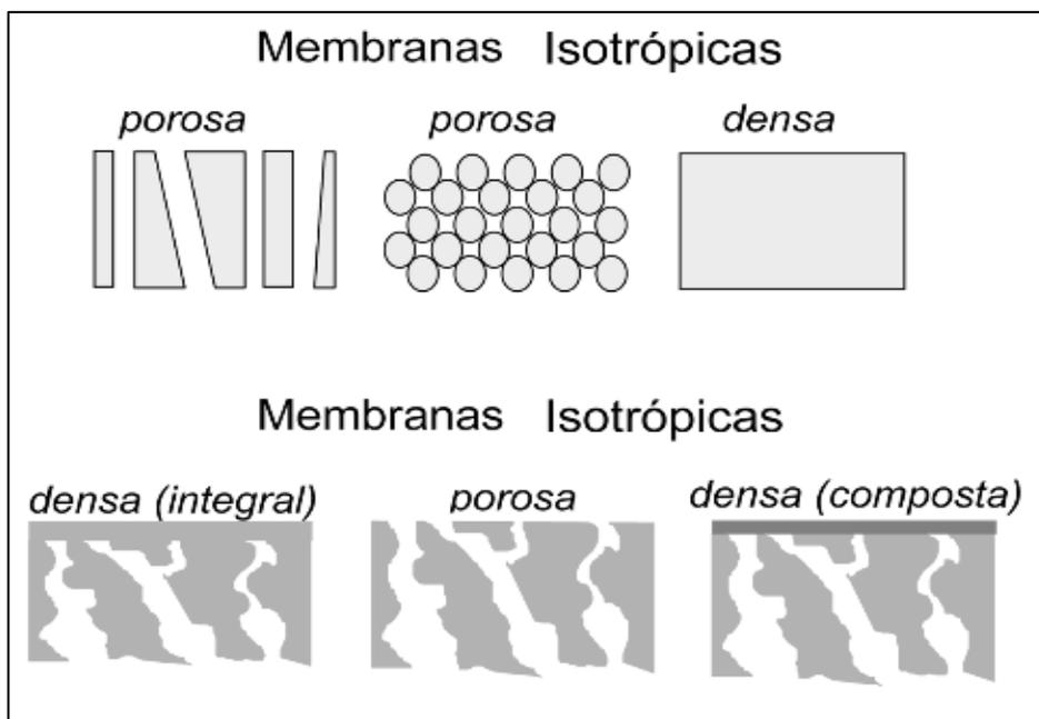
**Figura 2.13** - Esquema da morfologia da seção transversal de diferentes membranas. Adaptado de HABERT *et al.* (2006).
