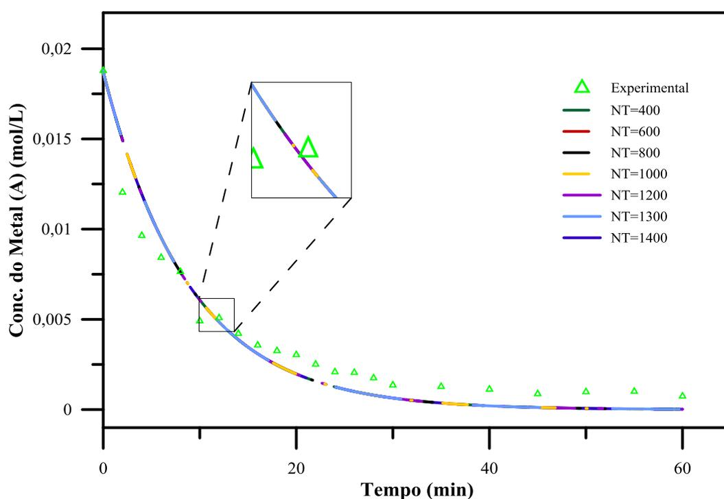
**Figura 4.19** – Análise gráfica de convergência para a cinética de extração do cobre através do perfil de concentração do metal utilizando o sistema de contactor com membranas.
