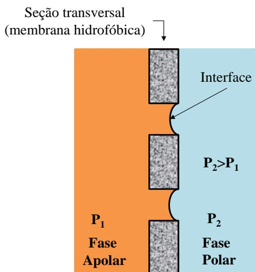
**Figura 2.24** - Interface entre a fase apolar e a fase polar em um contactor com membrana hidrofóbica. Adaptado de DRIOLI et al., (2005).
