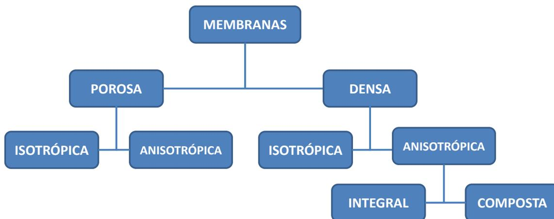
**Figura 2.11** - Classificação das membranas quanto à morfologia.
