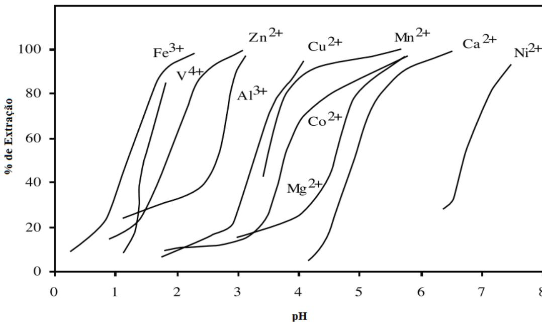
**Figura 2.9** - Extração de metais utilizando Cyanex 272 como extratante, de acordo com a faixa de pH, a partir de soluções de sulfato (CYTEC, 2008).
