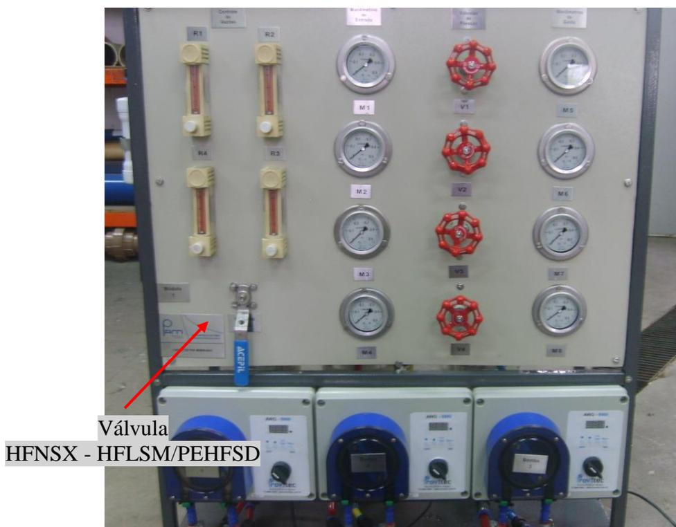
**Figura 4.9** – Vista frontal do protótipo em escala piloto do sistema de extração de metais por membranas contactores.
