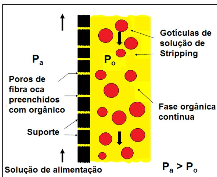
**Figura 2.29** - Representação esquemática do processo PEHFSD nas proximidades da parede da membrana. Adaptado de VILT (2010).
