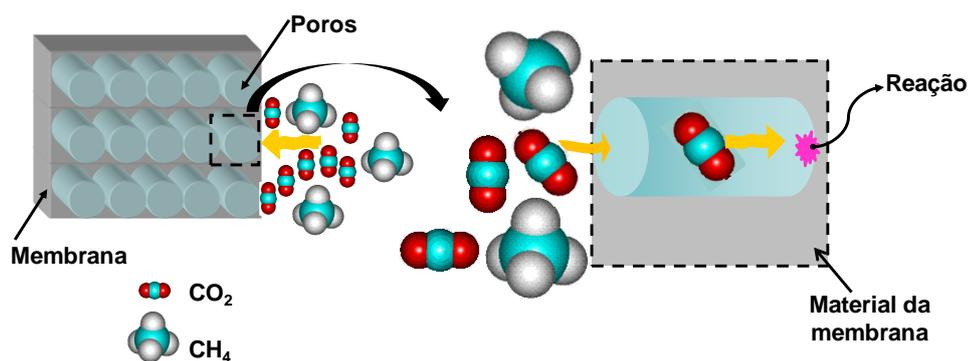
**Figura 2.22** - Esquema da remoção de moléculas de  $\text{CO}_2$  de uma mistura de gás natural rico em  $\text{CH}_4$  empregando membrana polimérica porosa com superfície reativa (CARDOSO, 2010).
