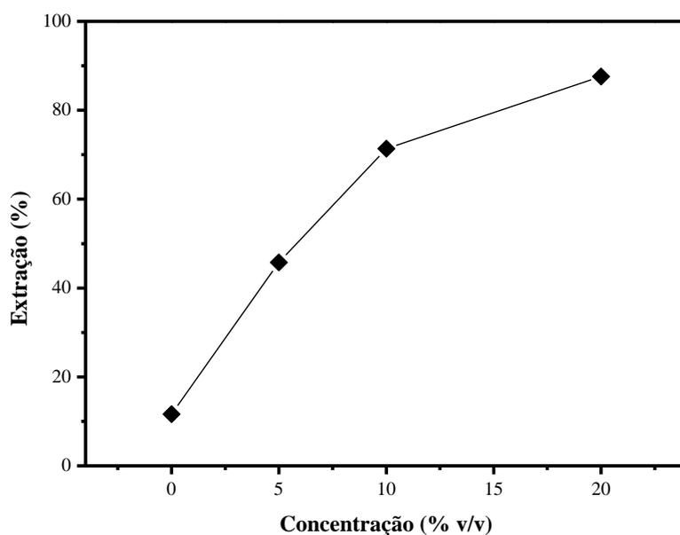
**Figura 4.10** - Influência da concentração do extratante LIX 84I na extração de cobre utilizando querosene como solvente, pH inicial=4,0, T=25°C, Cu=1,194 g/L, Extratante=0, 10 e 20%(v/v), tempo = 30 min.
