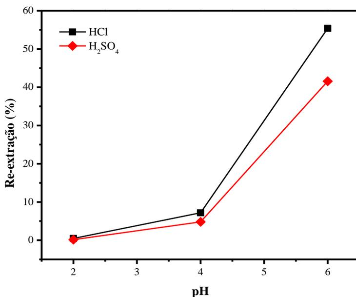
**Figura 4.7** – Influência da solução de *strip* em função do pH inicial na re-extração utilizando Cyanex 272 como extratante, Querosene como solvente, T=25°C, Cu=1,194 g/L, Extratante=20%(v/v).
