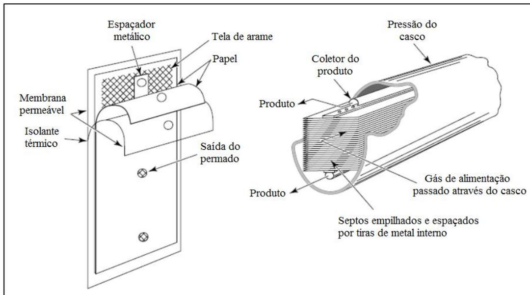
**Figura 2.14** - Representação esquemática de um módulo placa e quadro usado para separação de hélio de gás natural. Adaptado de BAKER (2004).
