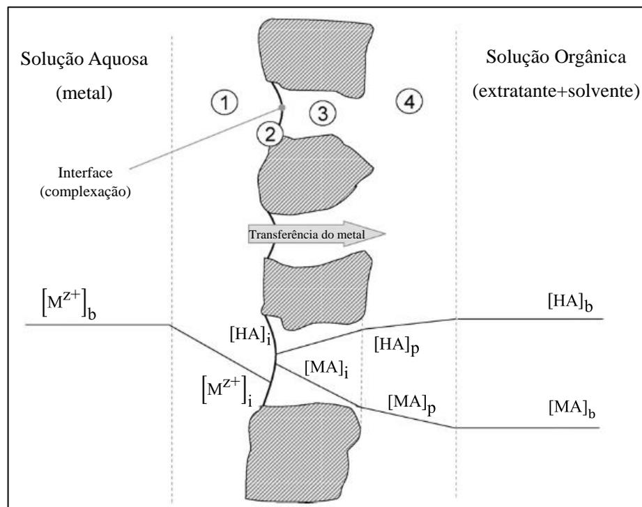
**Figura 2.28** – Transferência de massa e perfil de concentração do metal ( $M^{Z+}$ ), extratante (HA) e complexo (MA) nas proximidades da membrana. Os subscritos 'b', 'p' e 'i' representam as condições de *bulk* (seio), poro e interface, respectivamente. Adaptado de VALDÉS (2009).
