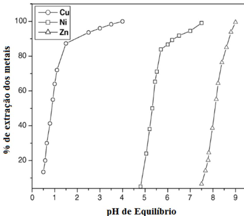
**Figura 2.8** – Efeito do pH na porcentagem de extração de metais, usando Cu(II), Ni(II), Zn(II): 0,0025M, LIX 84I: 0,005M (REDDY e PRYA, 2005).
