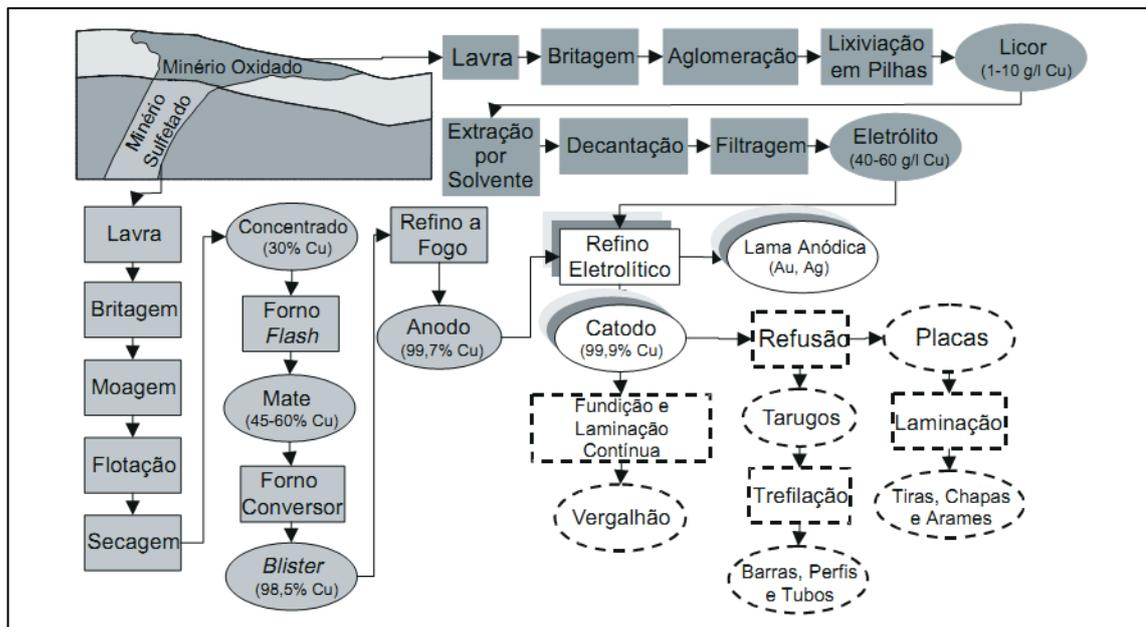
**Figura 2.1** – Rotas tecnológicas para a produção de Cobre (DE ANDRADE, 2001).
