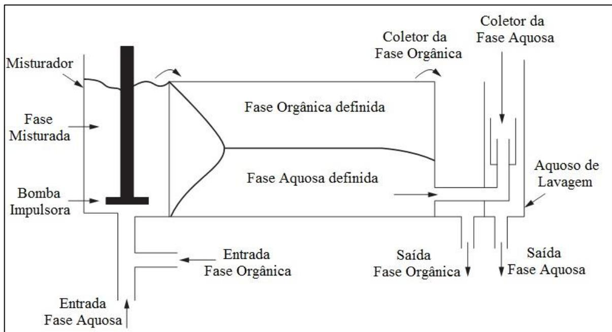
**Figura 2.4** – Unidade misturador-separador convencional (adaptado de WALLIS e CHLUMSKY, 1999).
