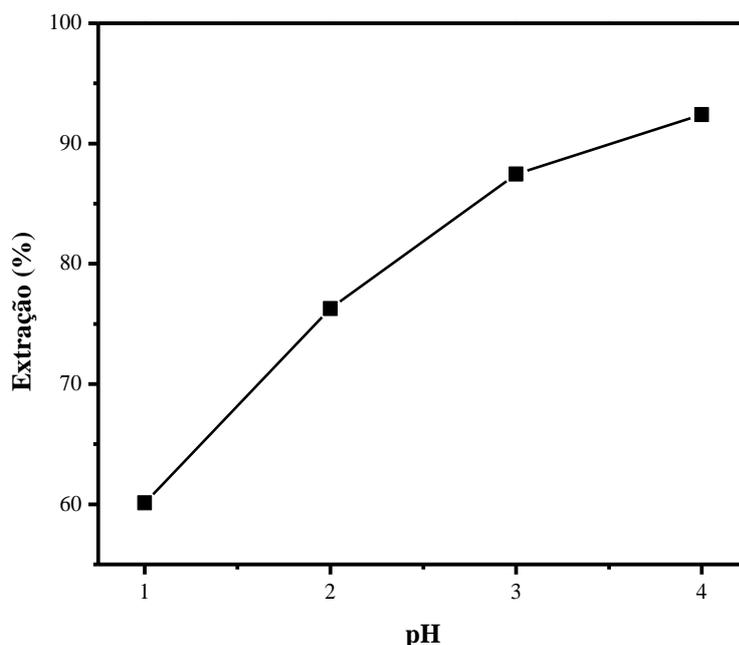
**Figura 4.5** - Influência do pH na extração por solvente de cobre em batelada utilizando LIX84I como extratante, Querosene como solvente,  $T=25^{\circ}\text{C}$ ,  $\text{Cu}=1,194 \text{ g/L}$ , Extratante=20%(v/v).
