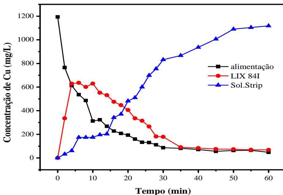
**Figura 4.16** - Cinética de extração e re-extração do cobre através do sistema de contactor com membranas utilizando LIX84I como extratante, Querosene como solvente, pH inicial=4, T=25°C, Cu=1,194 g/L, Extratante=20%(v/v), Strip (H<sub>2</sub>SO<sub>4</sub>)=2M.
