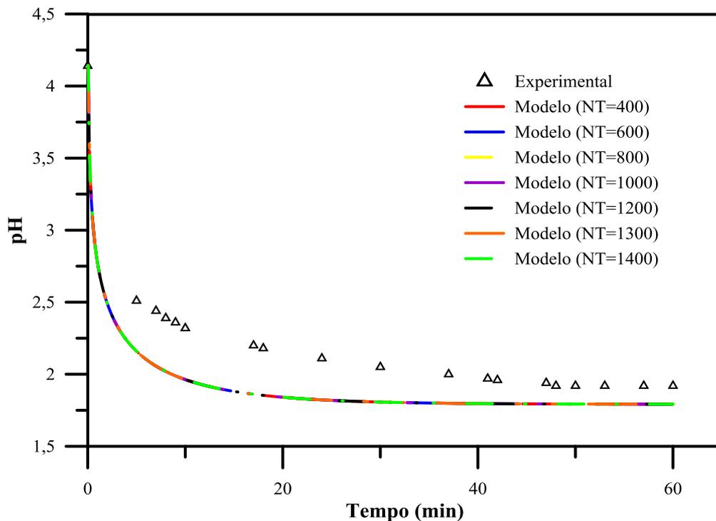
**Figura 4.20** – Análise gráfica de convergência para a variação do pH no tanque de alimentação utilizando o sistema de contactor com membranas.
