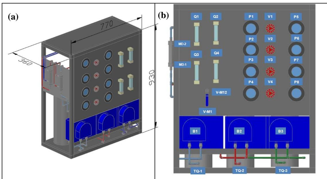
**Figura 3.6** – sistema de contactor com membranas (a) *layout* em 3D com as respectivas cotas em milímetros; (b) Painel de controle do sistema com a descrição dos seus componentes.
