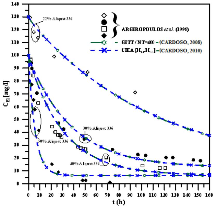
**Figura 2.30** - Comparação dos resultados de extração de Au(II) obtidos através da CIEA  $[H_{1,1}/H_{0,0}]$  e GITT, para a análise da influência da concentração de Aliquat 336 na membrana (CARDOSO, 2010).
