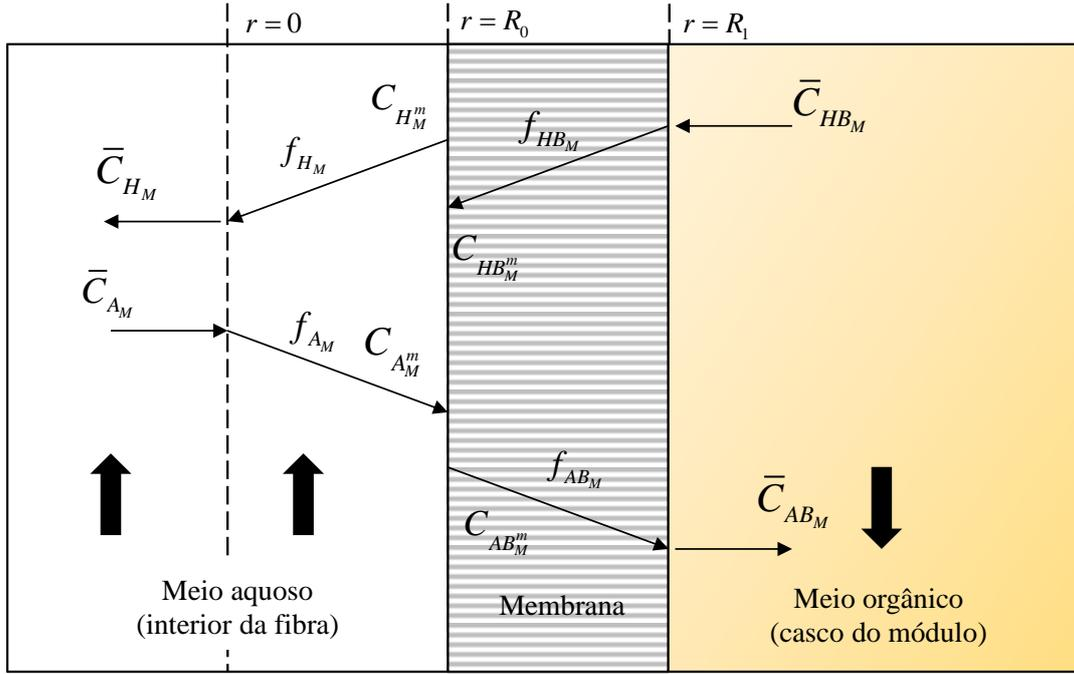
**Figura 3.8** – Representação esquemática ampliada do mecanismo de transporte no seio da solução aquosa, orgânica e na fase membrana.
