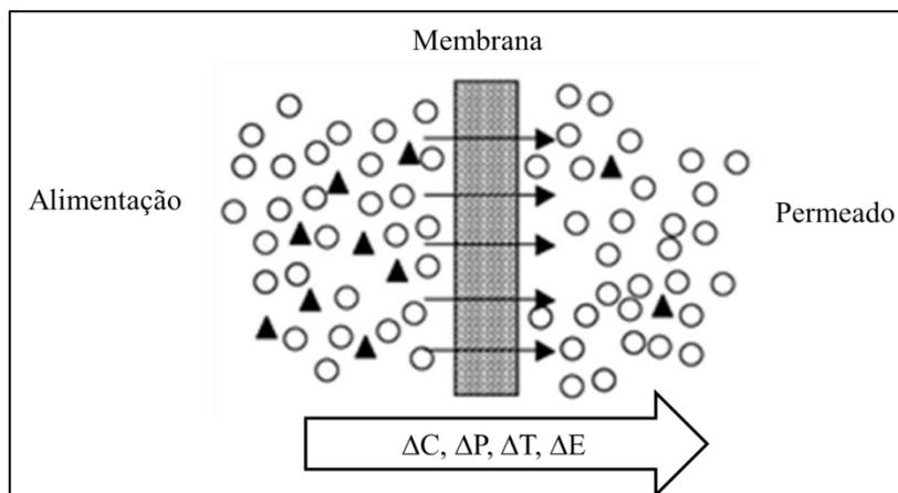
**Figura 2.10** - Representação esquemática de um processo de separação por membrana. Adaptado de STANOJEVIÓ *et al.* (2003).
