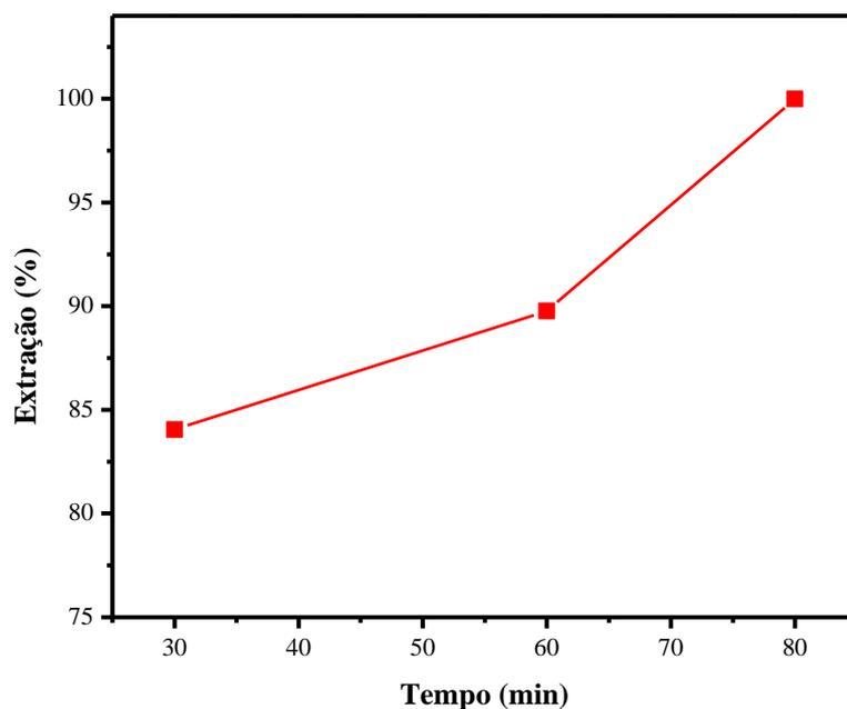
**Figura 4.13** - Influência do tempo de operação na recuperação do cobre utilizando LIX 84I como extratante e Querosene como solvente e pH (constante)=4, T=25°C, Cu=1,194 g/L, Extratante=20% (v/v), tempo = 30, 60 e 80min.
