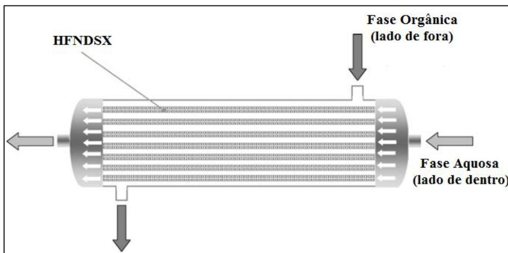
**Figura 2.27** – Descrição de um módulo simples de contactor com membranas do tipo HFNDSX. Adaptado de VALDÉS (2009).
