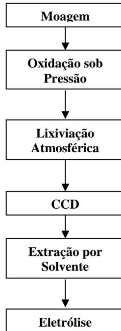
**Figura 3.2** – Diagrama de Blocos Simplificado do processo da UHC.
