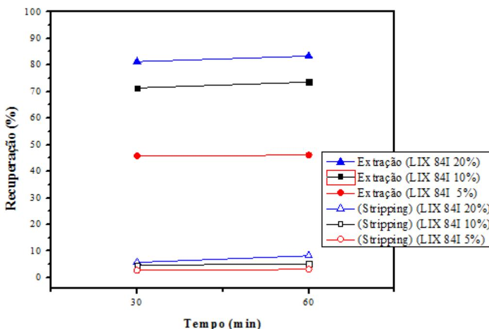
**Figura 4.11** - Influência do tempo de operação na recuperação do cobre utilizando LIX 84I como extratante e Querosene como solvente, pH inicial=4, T=25°C, Cu=1,194 g/L, Extratante=5, 10 e 20%(v/v), tempo = 30 e 60 min.
