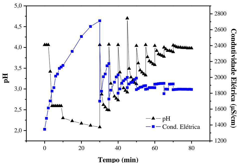
**Figura 4.14** - Variação e correções do pH e da condutividade elétrica ao longo do tempo na extração de cobre por membranas contactores utilizando LIX84I como extratante, Querosene como solvente, pH inicial=4, T=25°C, Cu=1,194 g/L, Extratante=20%(v/v).
