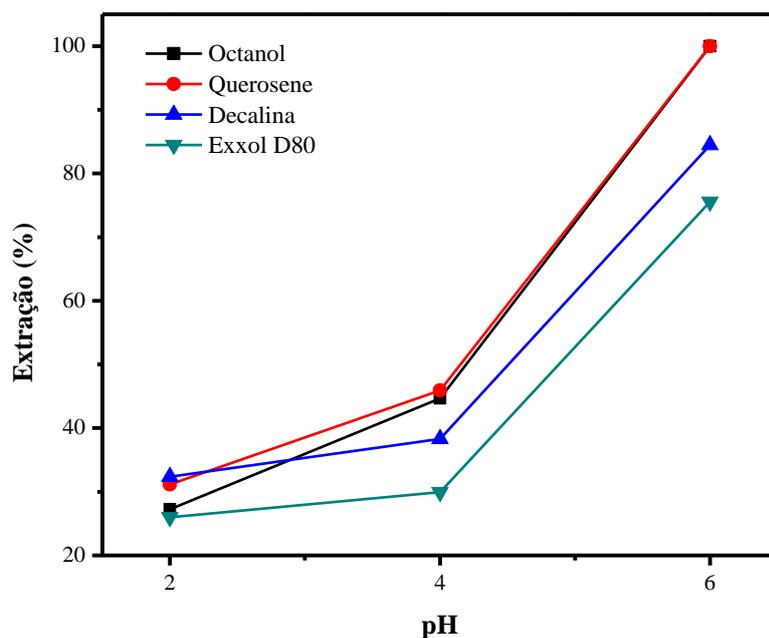
**Figura 4.4** - Influência do pH em função do solvente na etapa de extração de cobre em batelada utilizando Cyanex 272 como extratante,  $T=25^{\circ}\text{C}$ ,  $\text{Cu}=1,194 \text{ g/L}$ , Extratante=20%(v/v).
