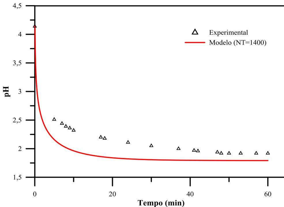
**Figura 4.18** - Comparação dos resultados experimentais e simulados da curva de variação temporal do pH no tanque de aquoso durante a extração do metal.
