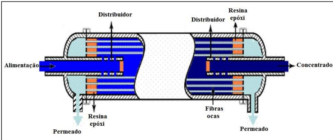
**Figura 2.16** - Esquema de um módulo de membrana de fibras-ocas (PAM MEMBRANAS).
