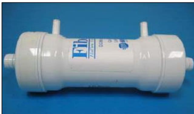
**Figura 3.4** – Fotografia do módulo de membranas microporosas.
