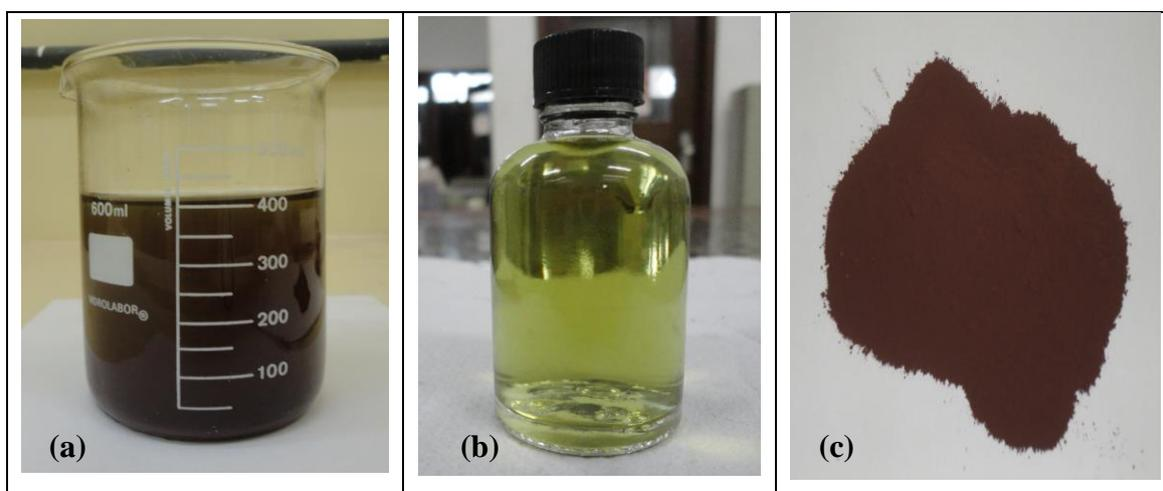
**Figura 4.1** - Pré – tratamento do rejeito: (a) Polpa do rejeito bruto; (b) fase aquosa do rejeito após filtração; (c) fase sólida do rejeito após secagem.
