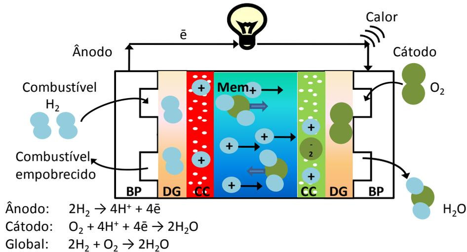
**Figura 2.19** - Esquema do transporte de matéria numa célula combustível PEM devido à diferença de potencial eletroquímico por potencial elétrico. Adaptado de DEVANATHAN (2008).
