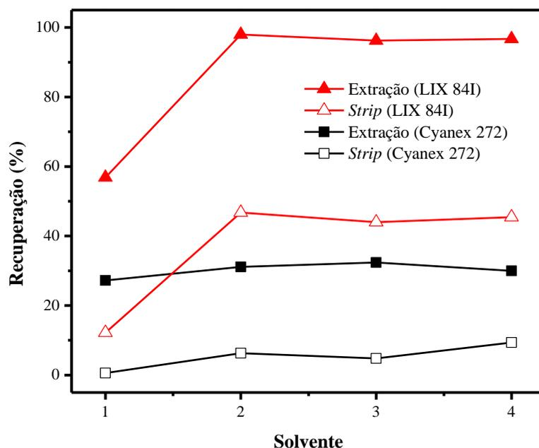
**Figura 4.3** – Influência do tipo de extratante e solvente na recuperação de cobre em batelada utilizando Cyanex 272 e LIX 84I como extratantes e Octanol (1), Querosene (2) Decalina (3) e Exxol D80 (4) como solventes, pH inicial=4, T=25°C, [Cu]=1,194 g/L, [Extratante]=20%(v/v).
