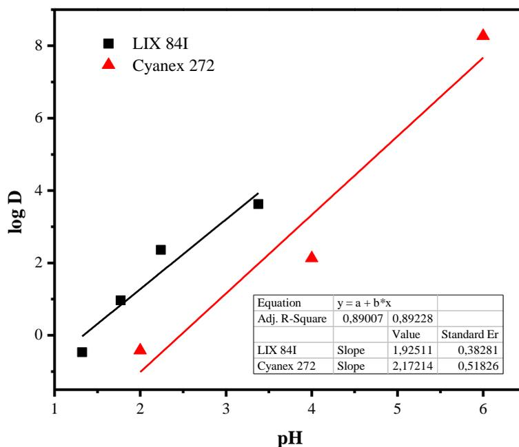
**Figura 4.8** – Determinação do coeficiente de distribuição através da linearização do plote de log D versus pH.
