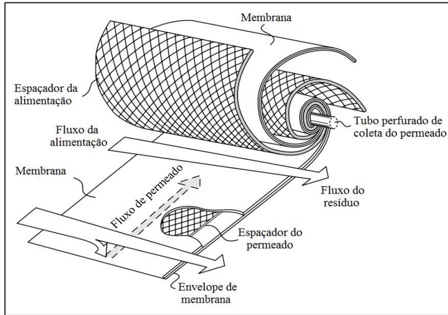
**Figura 2.15** - Representação esquemática de um módulo espiral. Adaptado de BAKER (2004).
