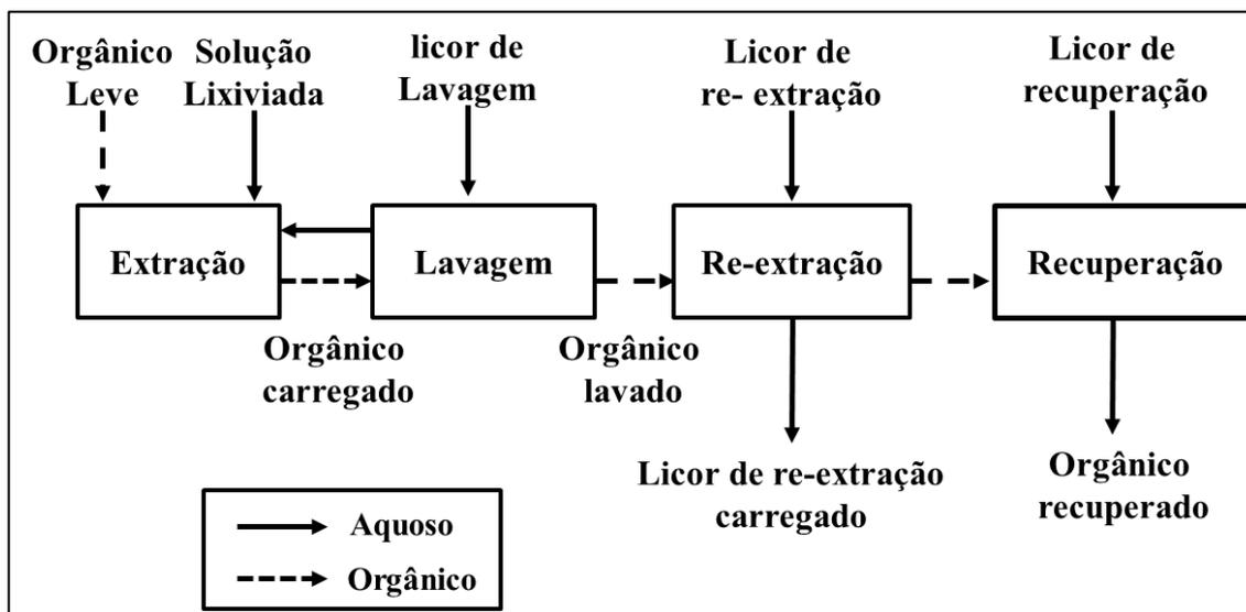
**Figura 2.3** – Circuito de extração por solvente generalizado (adaptado de SOLE, 2008).
