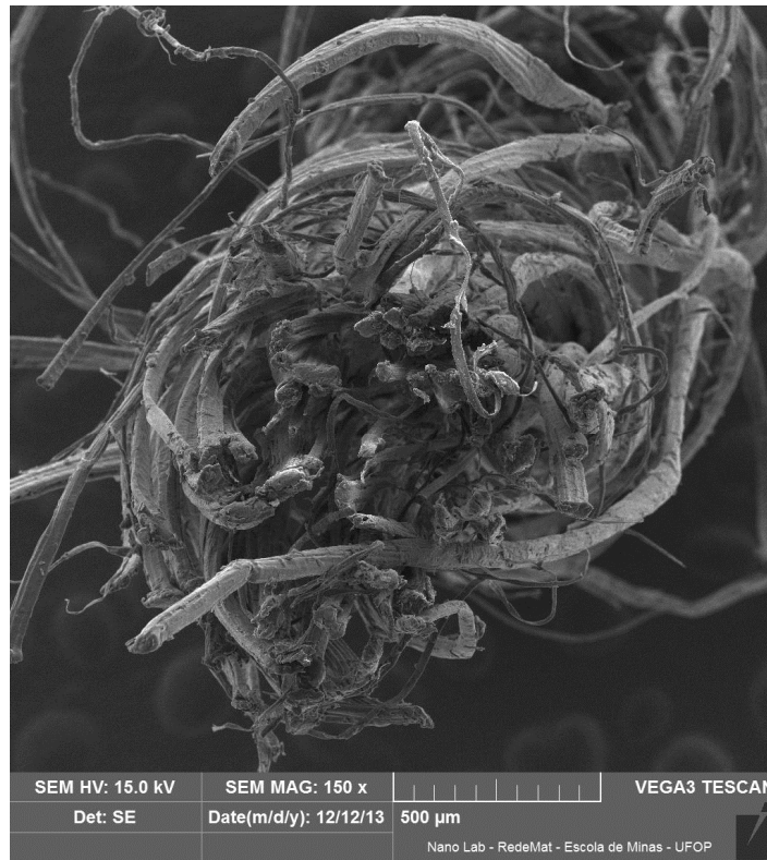
Figura 45: Aspecto das fibras que compõem o fio de juta.
