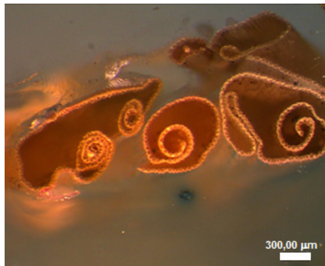
Figura 48: Seção transversal de corpo de prova reforçado com fibras alinhadas de palha da costa embutido observado ao estereoscópio.
