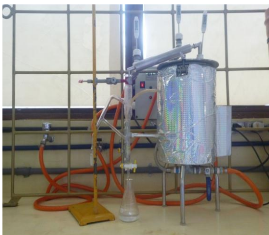
Figura 4.25 – Extrator de óleos essenciais por arraste com vapor e água marca Linax (Fonte: MORAES, 2012)
