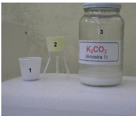
Figura 4.31 – Recipiente de polietileno (1); suporte de plástico (2) e frasco de vidro contendo solução salina saturada (3) (Foto: Eduardo Mafra)
