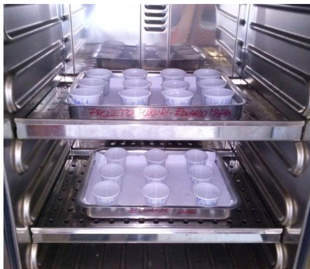
Figura 4.35 – Amostras colocadas em estufa de secagem e esterilização para a obtenção da massa de sólido seco (Foto: Eduardo Mafra)
