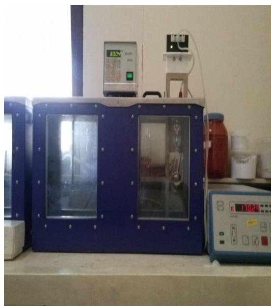
Figura 4.29 – Estação de medição de viscosidade com duas unidades de viscosímetros e controlador de temperatura de imersão (Foto: Eduardo Mafra)
