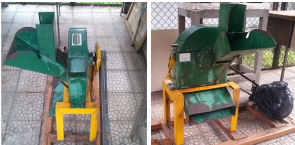
Figura 4.18 – Moinho de martelo utilizado para reduzir as dimensões do material de estudo (sementes, folhas e ramos finos) (Foto: Eduardo Mafra)
