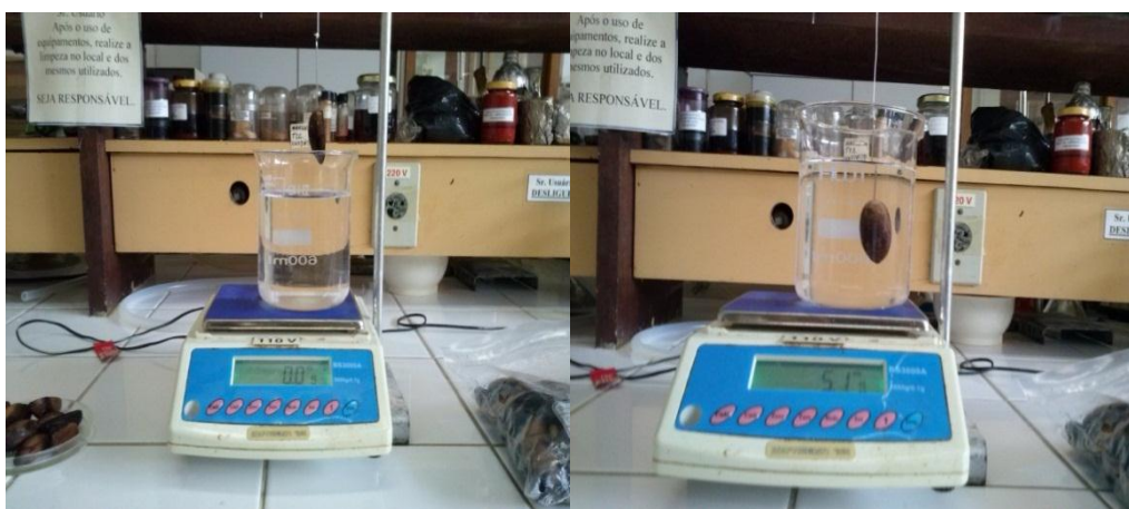
Figura 4.10 – Aparato usado para determinar o volume das sementes pelo Método Hidrostático usando água destilada como líquido mostrando a semente antes da submersão (Foto: Eduardo Mafra)
