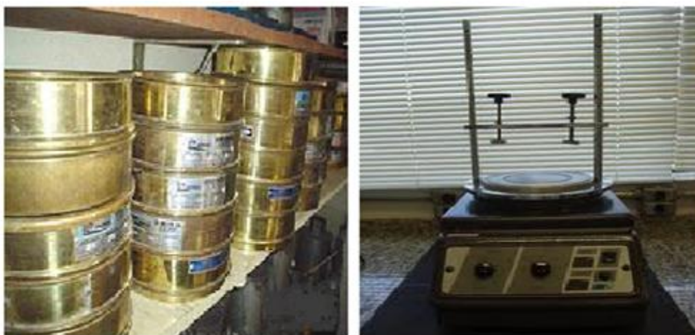
Figura 4.19 – Série de peneiras redondas Tyler, de aço e agitador mecânico de peneiras marca PRODUTEST de ½ HP 60 ciclos (Foto: Eduardo Mafra)
