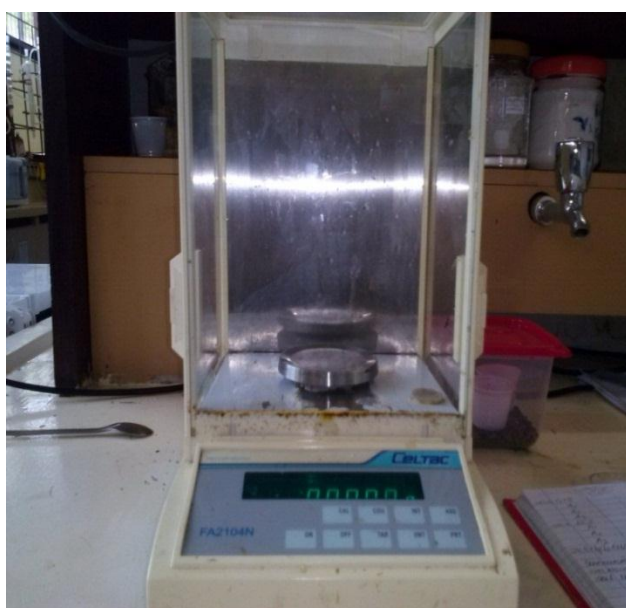
Figura 4.36 – Balança analítica para o acompanhamento da perda de umidade das amostras e obtenção da massa de sólido seco (Foto: Eduardo Mafra)
