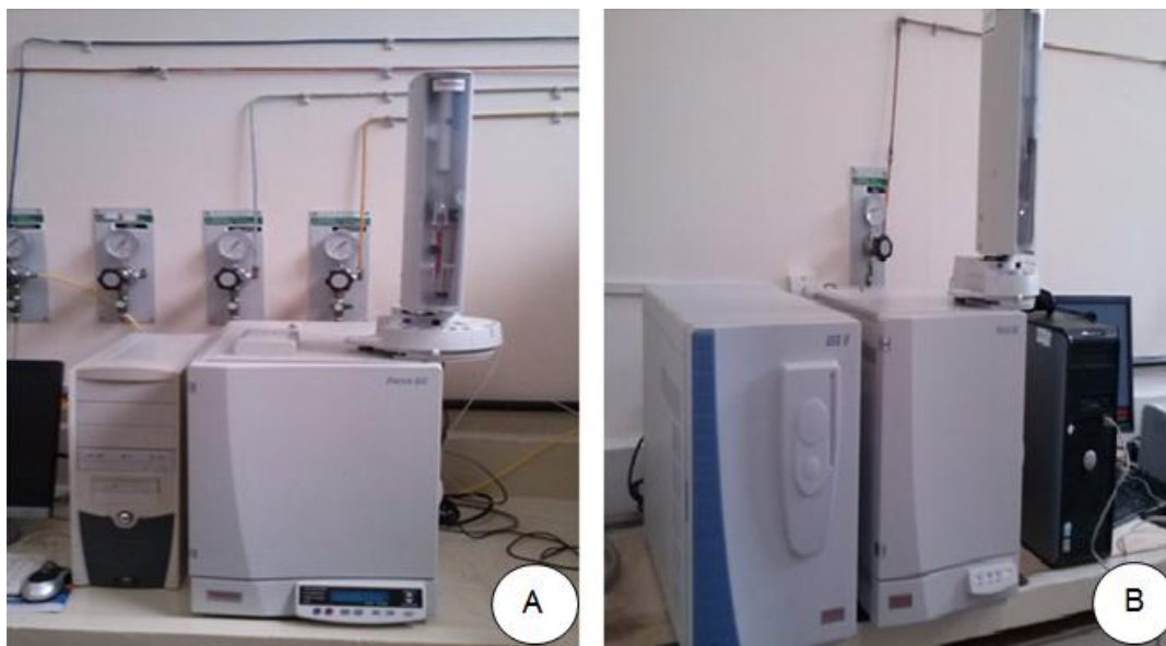
Figura 4.24 – Cromatógrafo de fase gasosa com ionização de chama para quantificar o óleo essencial (A); Cromatógrafo de fase gasosa acoplado a um espectrômetro de massa para qualificar o óleo essencial (B) (Foto: Eduardo Mafra).
