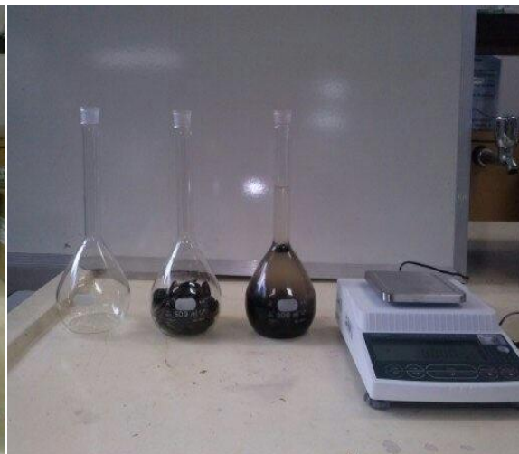
Figura 4.9 – Aparato usado para determinar a massa específica absoluta das sementes de puxuri por pycnometria de comparação (Foto: Eduardo Mafra)
