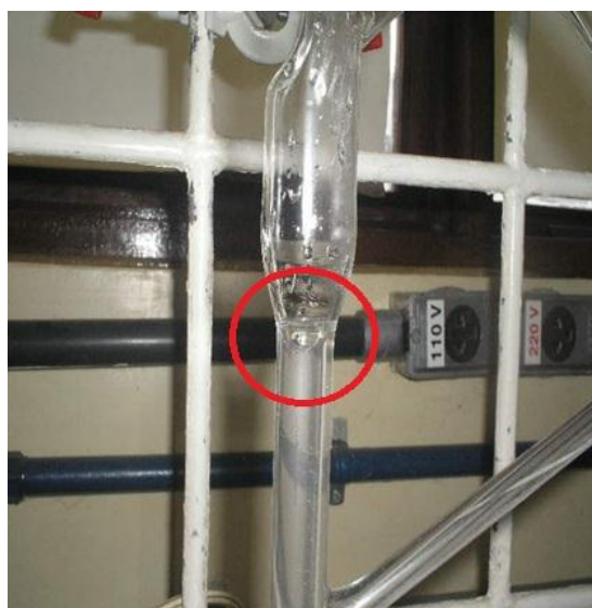
Figura 4.22 – Detalhe do óleo (círculo vermelho) durante a extração antes de precipitar (Foto: Eduardo Mafra)
