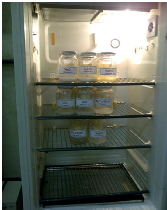
Figura 4.34 – Amostras colocadas em câmara de climatização estufa BOD (Foto: Eduardo Mafra)
