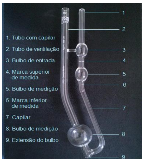
Figura 4.28 – Viscosímetro de Cannon-Fenske de capilar nº100 (Foto: Eduardo Mafra).
