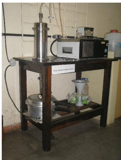
Figura 4.20 – Aparato usado para extração de óleo essencial por arraste com vapor desenvolvido por Faria Júnior e Faria (2008) (Foto: Eduardo Mafra)
