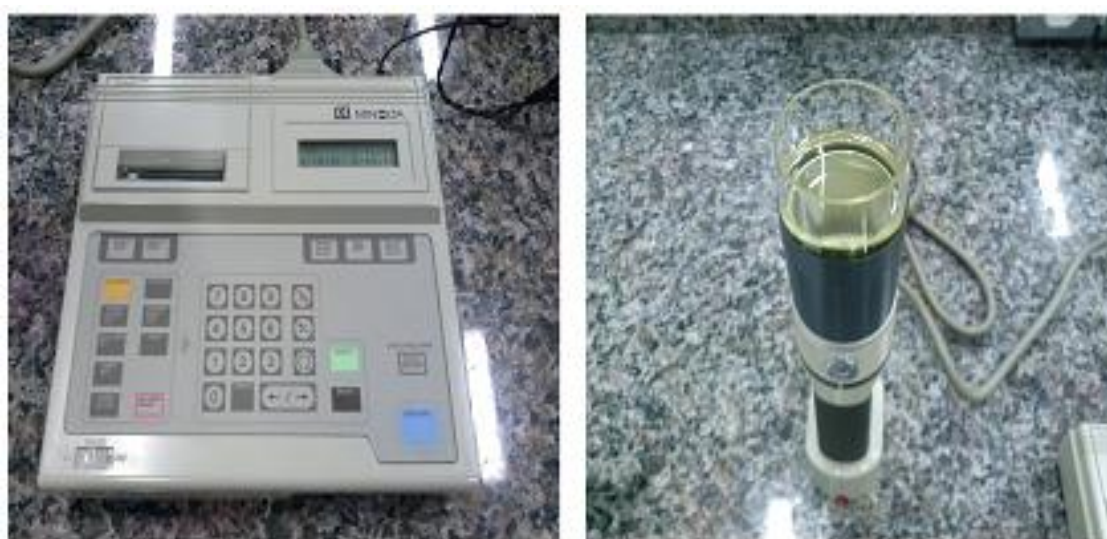
Figura 4.30 – Instrumento usado na análise colorimétrica do óleo essencial de puxuri (Foto: Eduardo Mafra)
