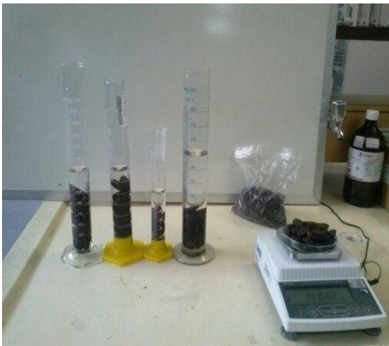
Figura 4.8 – Aparato usado para determinar a densidade das sementes de puxuri pelo método do deslocamento de líquidos (Foto Eduardo Mafra)
