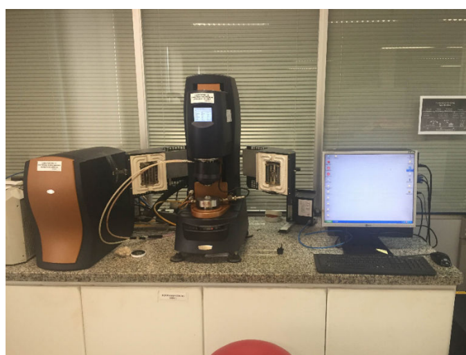
Figura 3.6 – Reômetro de cisalhamento dinâmico do Laboratório de Geotecnia da COPPE/UFRJ.
