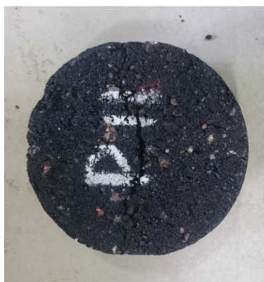
Figura 4.24 - Exemplo da ruptura dos corpos de prova a tração por compressão diametral.
