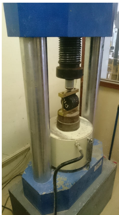
Figura 3.1 - Configuração do ensaio de resistência a tração realizados nesta pesquisa.
