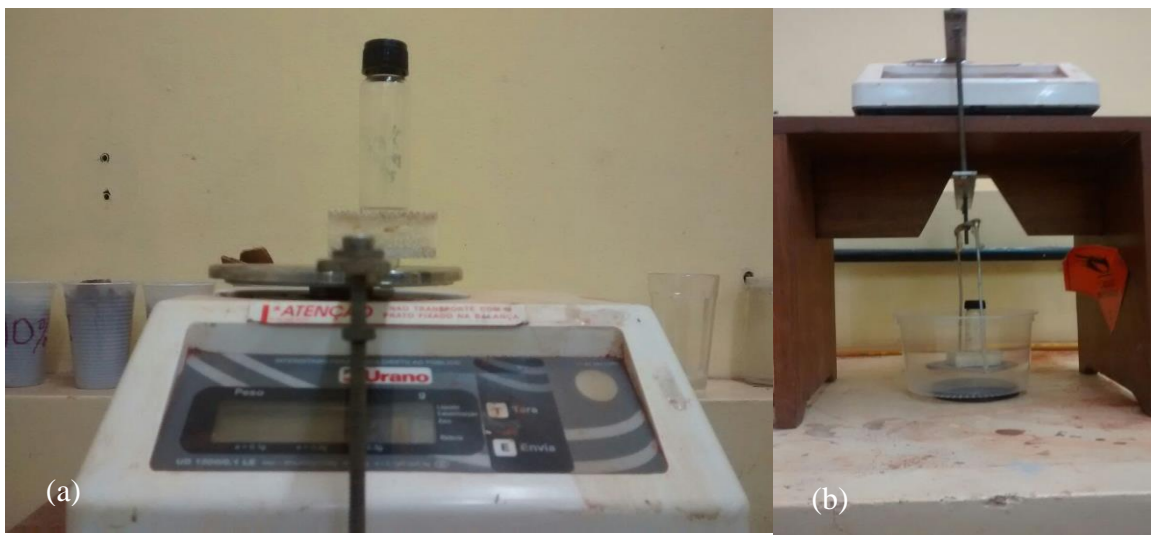
Figura 3.19 – Aparato para a determinação da massa específica aparente: (a) Obtenção da massa seca e da massa úmida do corpo de prova e (b) obtenção da massa imersa do corpo de prova.
