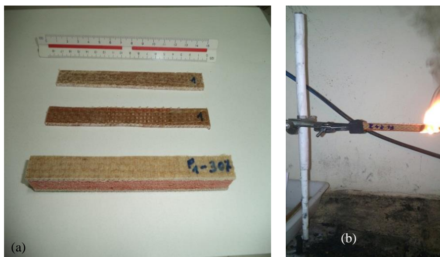
Figura 3.28 – Ensaio de flamabilidade: (a) cp's antes do ensaio: lâmina com caulim, lâmina sem caulim e a estrutura sanduíche (de cima para baixo, resp.) e (b) aparato de ensaio.
