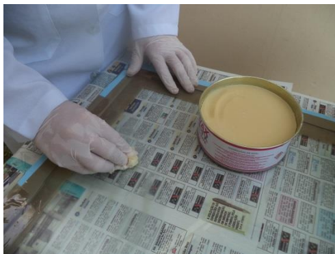
Figura 3.5 – Aplicação da cera desmoldante. Fonte: Própria.
