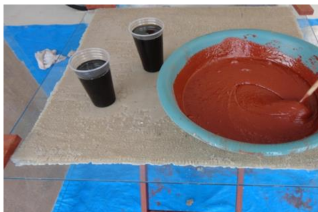
Figura 3.14 – Homogeneização da lama vermelha no poliuretano para depois, acrescentar o isocianato.
