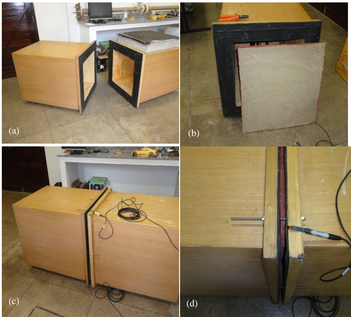
Figura 3.31 – (a) As duas minicâmaras abertas, (b) colocação do corpo de prova para o ensaio, (c) fechamento das minicâmaras com o corpo de prova entre elas e (d) detalhe do corpo de prova entre as minicâmaras aparafusadas. O cabo é o da fonte.
