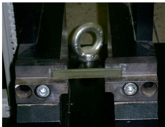
Figura 3.26 – Corpo de prova no porta amostra da máquina de ensaio de impacto. Fonte: RODRIGUES, (2008).
