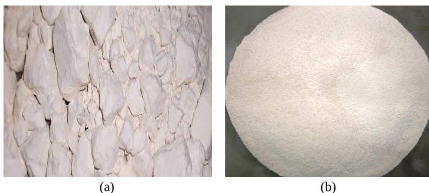
Figura 3.3 – (a) Caulim antes da cominuição e (b) Caulim após a cominuição.
