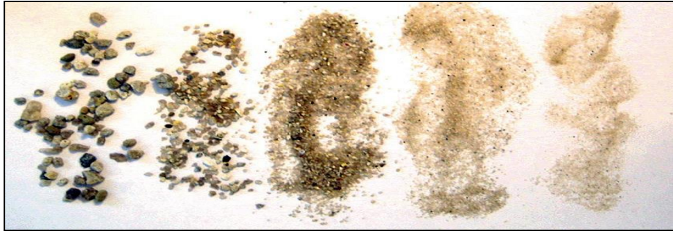
Figura 2.2- Forma e textura típica de areia de jazida tipo leito de rio. Fonte: PASSUELO, 2011 apud REIS, 2014.
