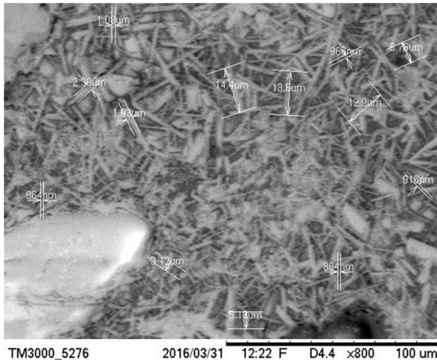
Figura 5.28 – Micrografia do agregado sintético do 3º experimento com ampliação de 800x
