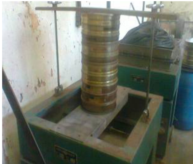
Figura 11 - Ro Tap com o seu conjunto de peneiras. Fonte: O AUTOR.
