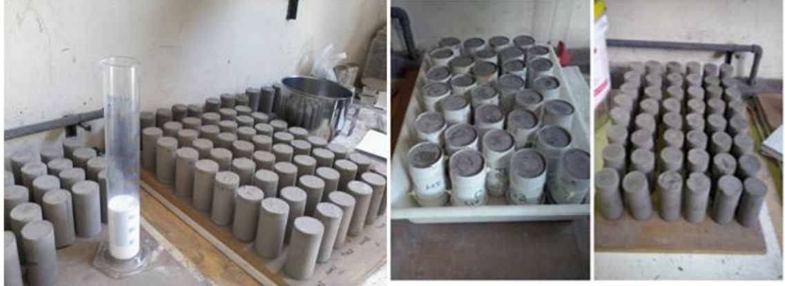
Figura 22: Corpos de prova dos traços de argamassa com e sem PVA
