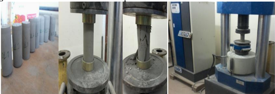
Figura 23: Ensaio de resistência à compressão
