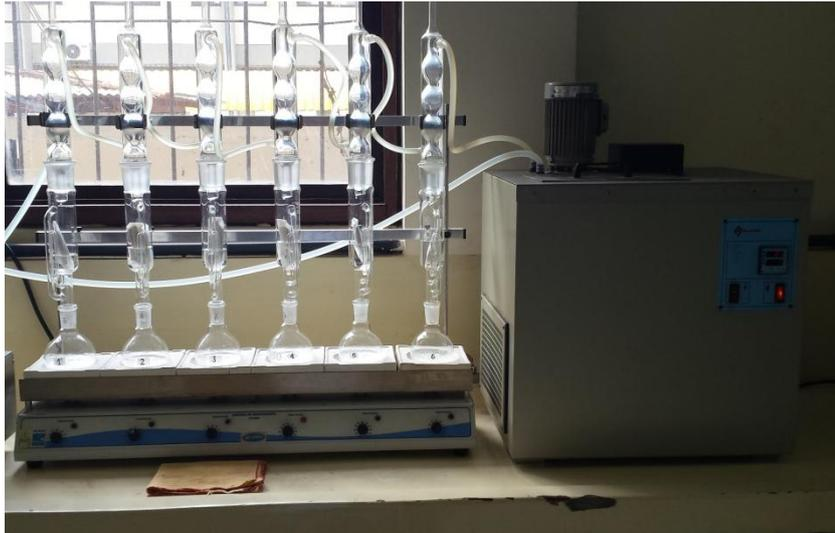
Figura 4.3 - Aparelho Soxhlet.
