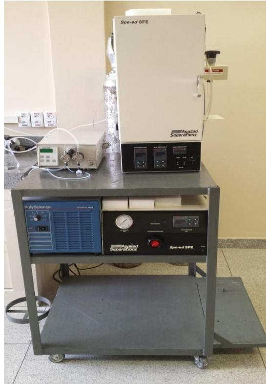
Figura 4.4 - Unidade de Extração Supercrítica do LABEX/FEA/UFPA.
