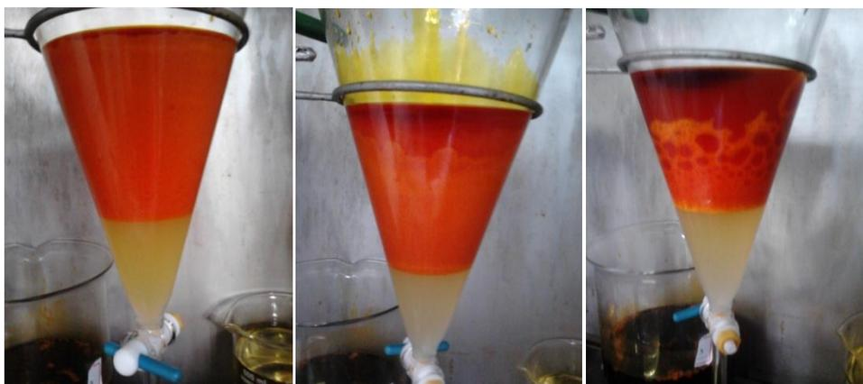
**Figura 32:** Processo de lavagem com 30% de água
