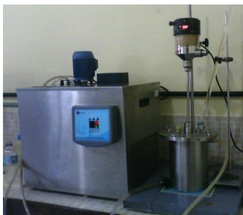
**Figura 15:** Sistema utilizado para a reação de neutralização.
