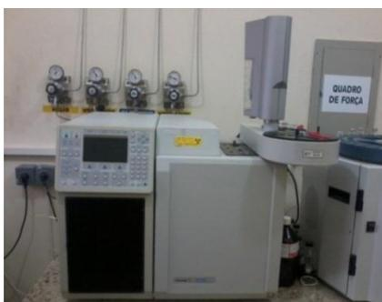
**Figura 26:** Cromatógrafo utilizado na análise do teor de éster.
