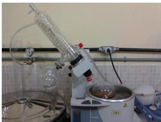
**Figura 21:** Equipamento utilizado na separação do etanol em excesso.
