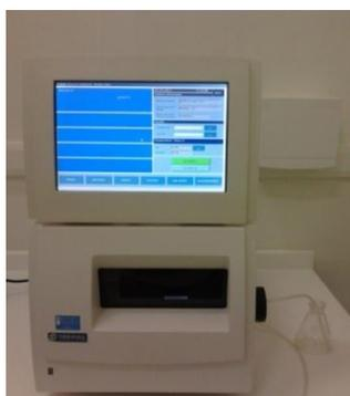
**Figura 13:** Densímetro utilizado na medição da densidade.
