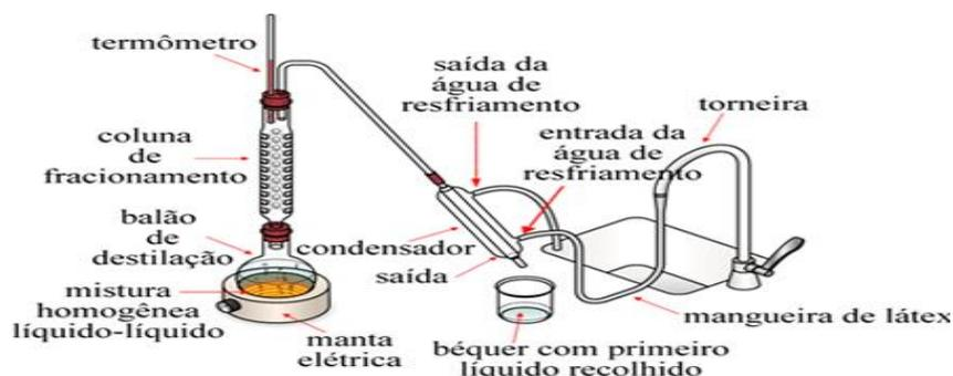
**Figura 3.12:** Esquema de Destilação Fracionada em Escala Laboratorial.
