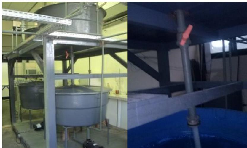
**Figura 4.31:** Sistema de Resfriamento da Unidade Piloto de Craqueamento.
