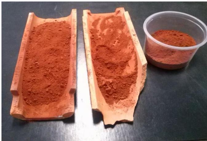
**Figura 4.17:** Lama vermelha antes do processo de calcinação.
