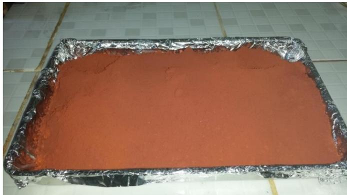
**Figura 4.36:** Lama Vermelha preparada para o Processo de Secagem em Estufa.
