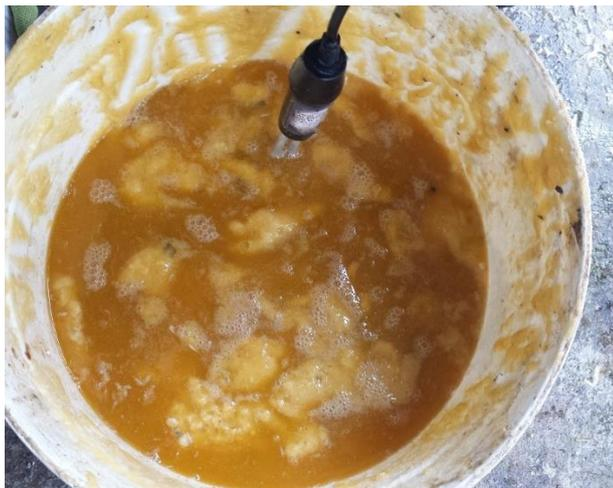
**Figura 4.4:** Liquefação da Gordura Residual.
