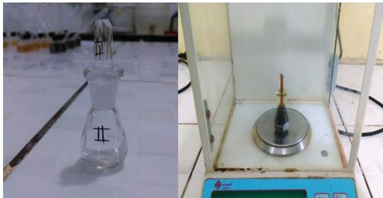
**Figura 4.49:** Picnômetro utilizado na determinação da densidade.
