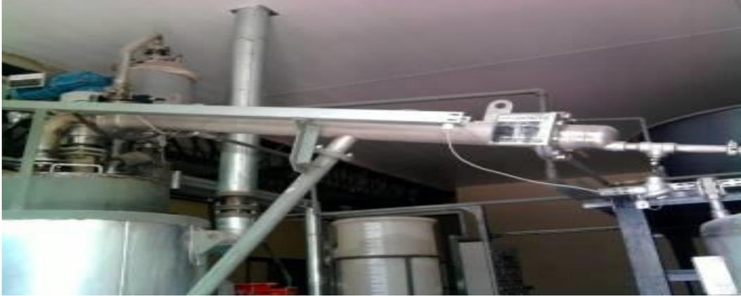
**Figura 4.32:** Condensador da Unidade Piloto de Craqueamento.
