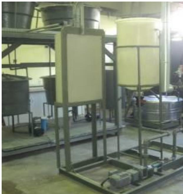
**Figura 4.26:** Sistema de Alimentação e Bombeamento da Unidade Piloto.
