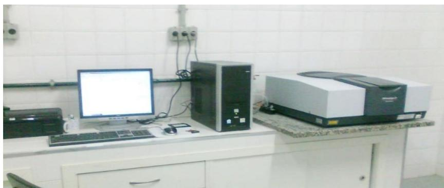
**Figura 4.51:** Espectrômetro FTIR.
