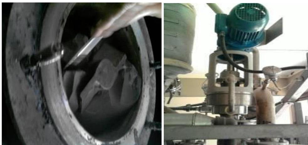
**Figura 4.29:** Sistema de Agitação da Unidade Piloto.
