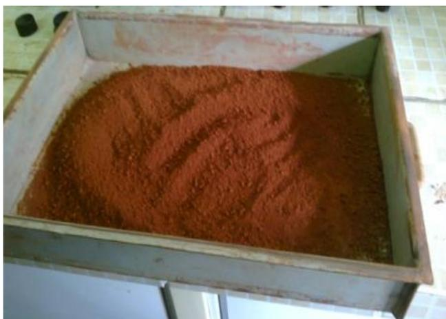
**Figura 4.16:** Lama vermelha após o processo de desagregação.
