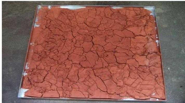
**Figura 4.14:** Lama vermelha após o processo de pré-tratamento térmico na estufa.
