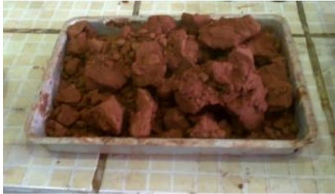
**Figura 4.13:** Lama vermelha antes do processo de pré-tratamento térmico na estufa.
