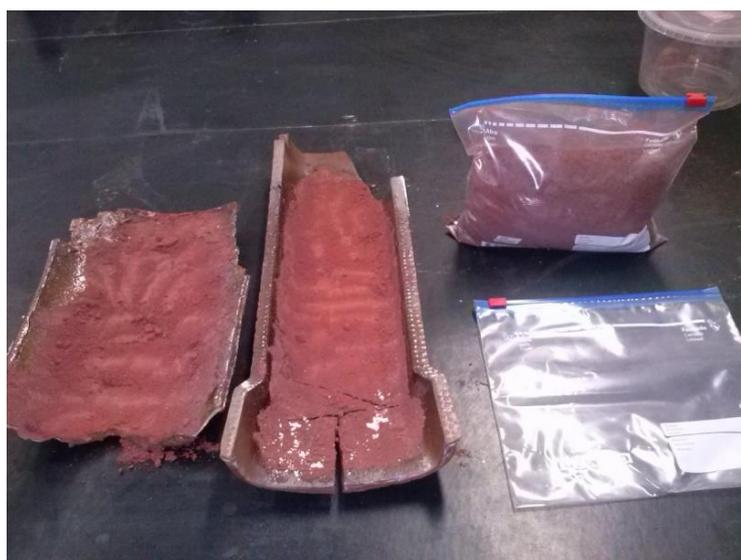
**Figura 4.18:** Lama vermelha após o processo de calcinação.
