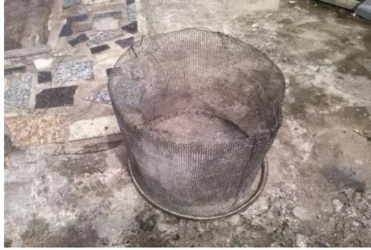
**Figura 4.6:** Sistema de Peneiramento.
