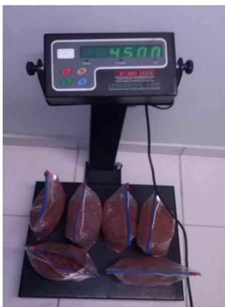
**Figura 4.20:** Pesagem da LV calcinada para o Processo de Craqueamento Térmico Catalítico.
