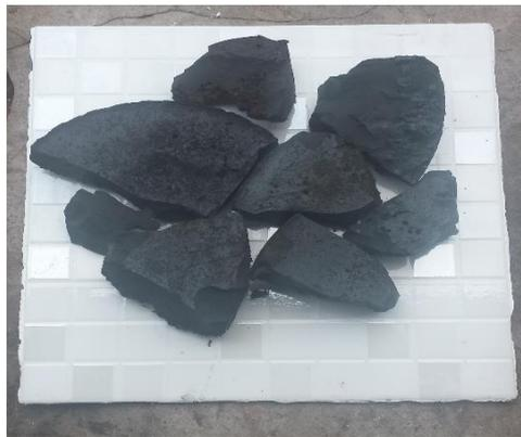
**Figura 4.40:** Coque retirado do Reator após o Processo de Craqueamento.
