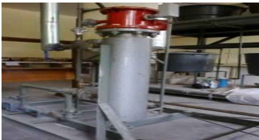
**Figura 4.27:** Pré-Aquecedor da Unidade Piloto de Craqueamento.
