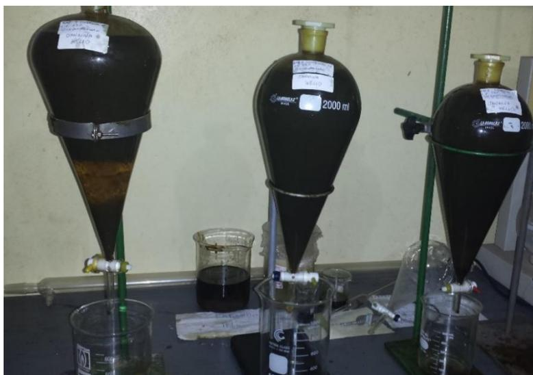
**Figura 4.42:** Processo de Decantação do PLO.
