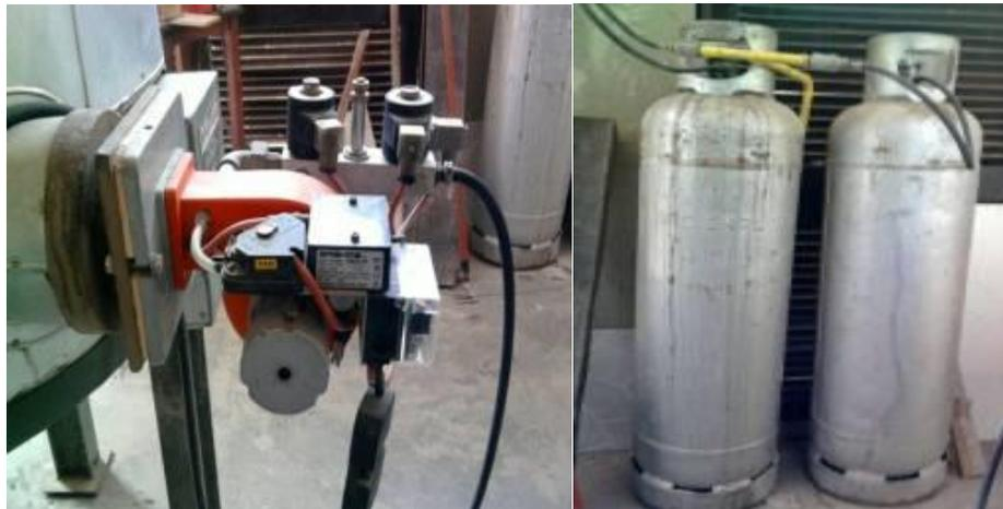
**Figura 4.30:** Sistema de Queima e os Cilindros de armazenamento de GLP.
