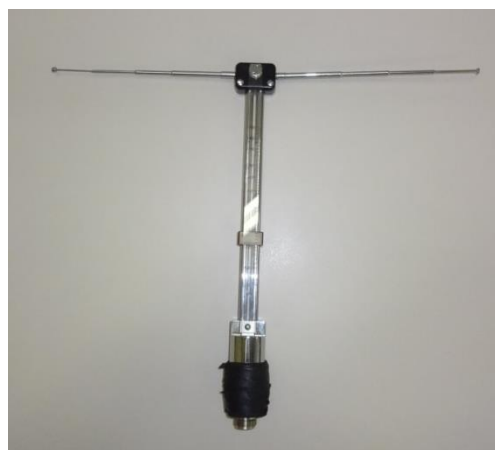
Fig. 5.3. Antena dipolo Anritsu MPP651A
