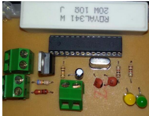
Figura 3.3 – Dispositivo para Programação de Controladores. (a) Foto da placa e (b) Diagrama de blocos.
