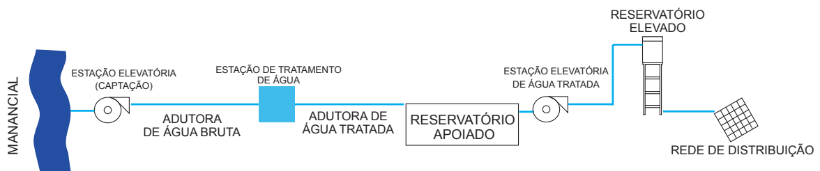
Figura 1: Sistema de abastecimento de água esquemático
