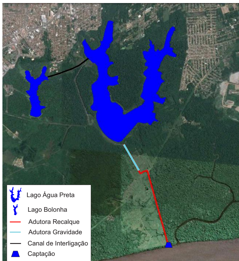
Figura 11: Esquema da captação do Sistema Bolonha - Utinga
