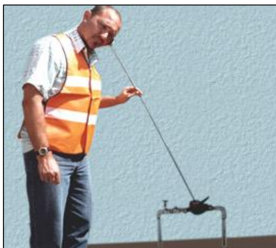
Fotografia 1 – Utilização de uma haste de escuta Fonte: Haste de escuta,(2009)
