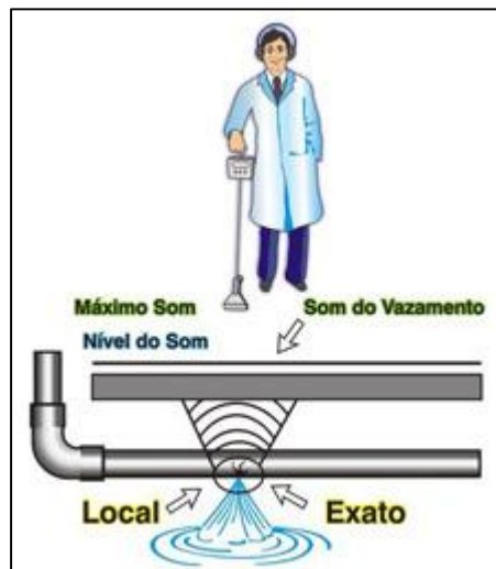
Figura 5 – Funcionamento de um geofone Fonte: Geofone, (2009)
