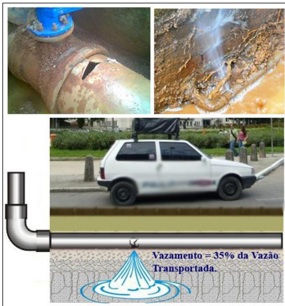
Figura 7 – Vazão e área de ruptura na rede de distribuição de água Fonte: Vazamento de água e Carro na Urca, (2009)
